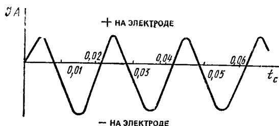
Рис. 8.2. Диаграмма, характеризующая причину появления постоянной составляющей тока
