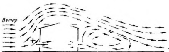
Рис. 2. Естественная вентиляция здания под действием ветрового напора
