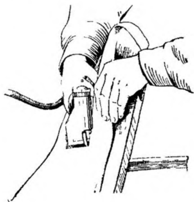
Рис 85. Приемы резания ручными электроножницами
