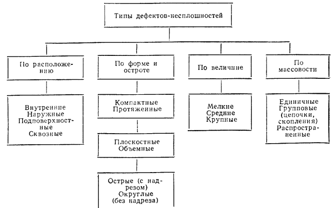
Рис. 4. Типы сварочных дефектов-неплошностей
