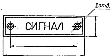
Рис. VI.6. Простановка размеров для нанесения надписи на изделии
