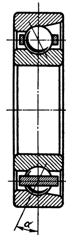
Рис. 24.10. Шариковый радиально-упорный подшипник
