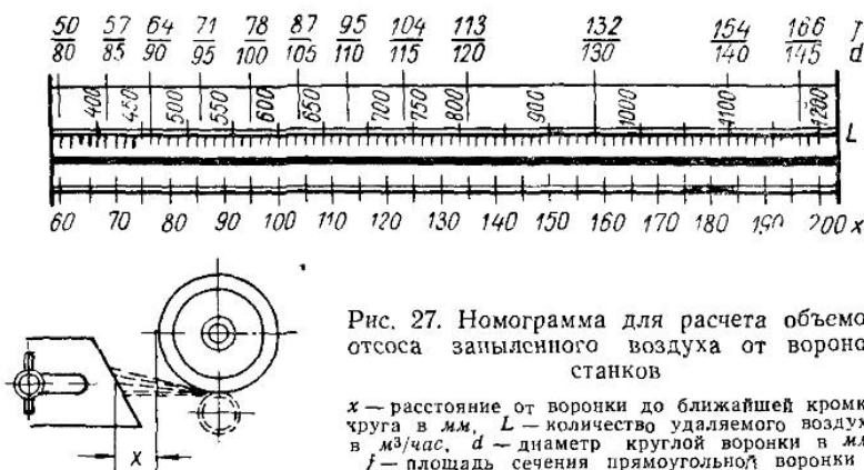
Рис. 27. Номограмма для расчета объемов отсоса запыленного воздуха от воронок станков
