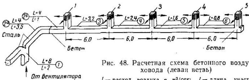
Рис. 48. Расчетная схема бетонного воздуховода (левая ветвь)
