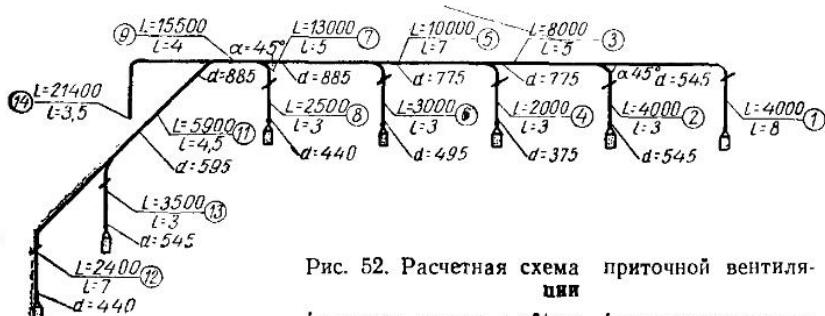
Рис. 52. Расчетная схема приточной вентиляции
