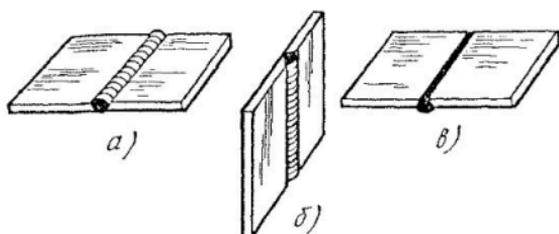
Рис. 93. Пространственные положения сварных соединений:
