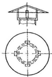
Рис. 45. Зонт для вытяжной шахты
