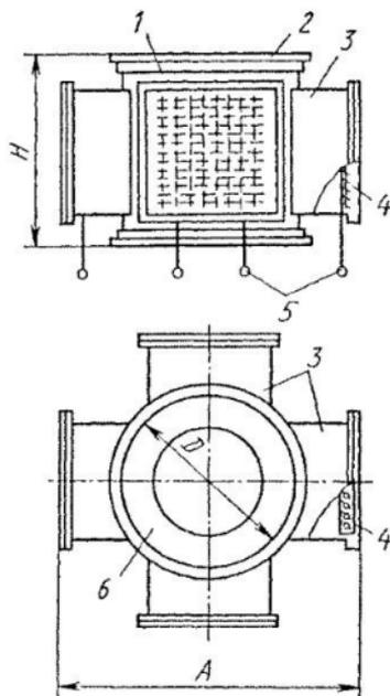
Рис. 31. Приколонный верный воздухораспределитель НРВ:
