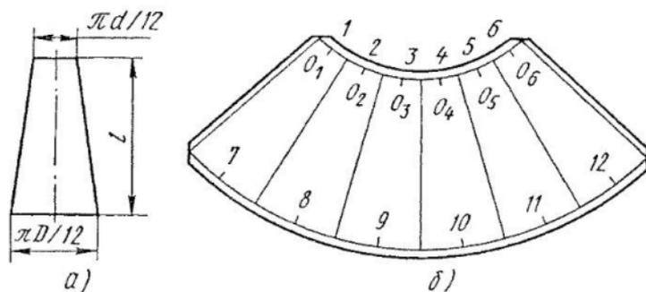
Рис. 89. Метод приближенного построения развертки перехода:
