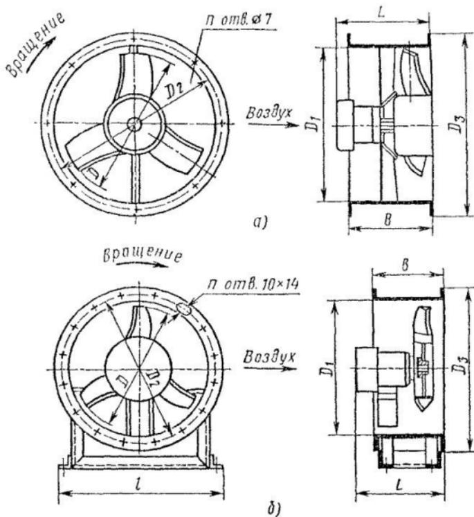
Рис. 13. Схемы осевых вентиляторов В-06-300:
