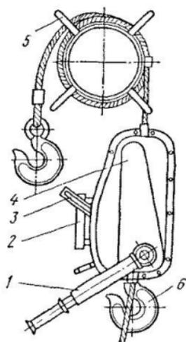
Рис. 69. Монтажно-тяговый механизм МТМ:
