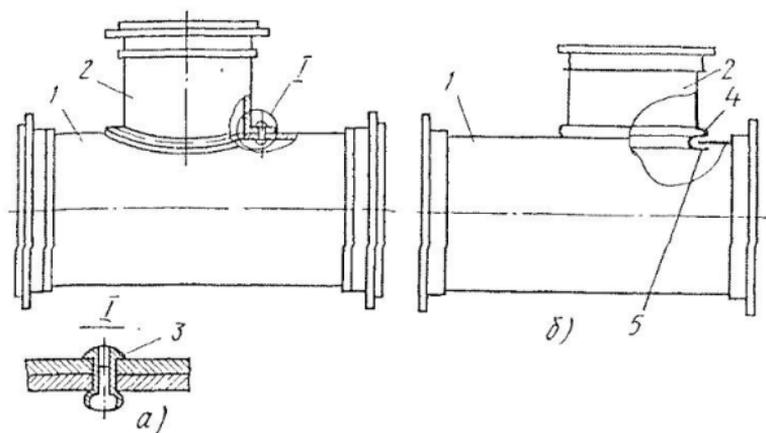
Рис. 83. Узлы ответвлений воздухопроводов с базовой врезкой:
