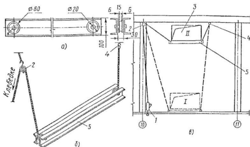
Рис. 134. Монтаж панельных воздуховодов с помощью траверсы: а — траверса, б — схема занасовки каната лебедки, в — последовательность монтажа, 1 — лебедка, 2 — грузовой блок, 3 — панельный воздуховод на проектной отметке, 4 — крепление троса лебедки, 5 — траверса
