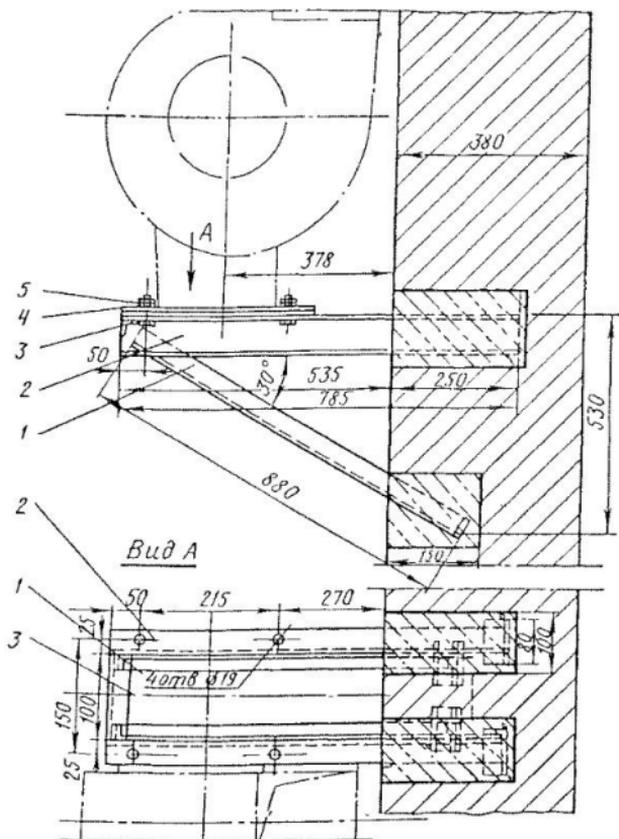
Рис. 103. Монтаж вентилятора В-Ц4-70 № 4 на кронштейнах:
