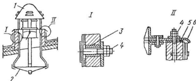
Рис. 105. Установка крышного вентилятора на железобетонном стакане:
