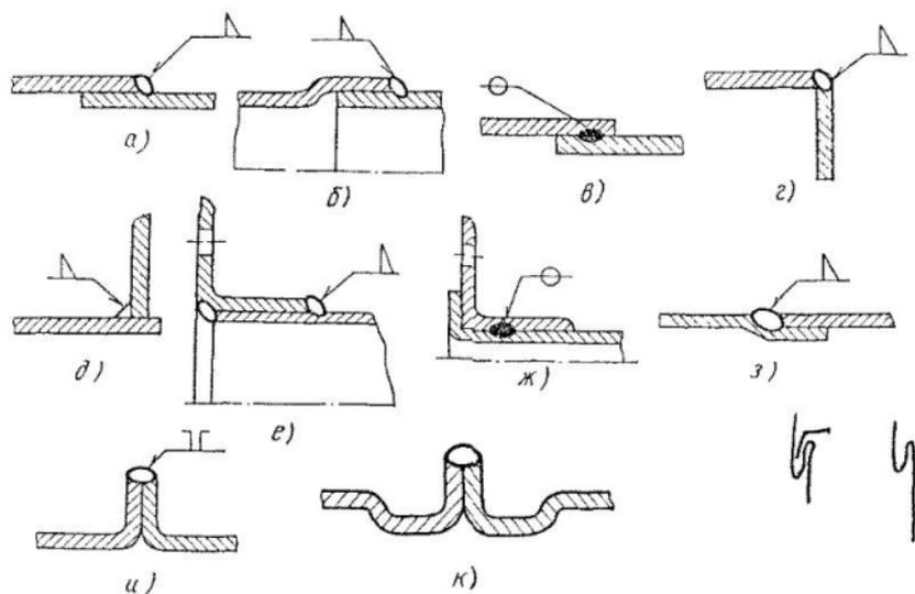
Рис. 84. Виды сварных соединений металлических воздухопроводов:
