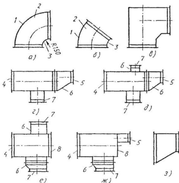
Рис. 28. Фасонные части прямоугольных воздуховодов:
