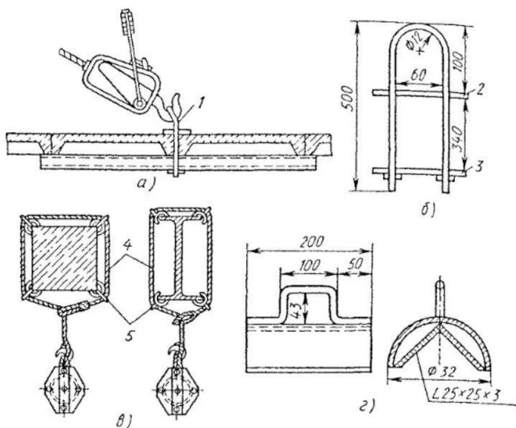
Рис. 101. Крепление монтажно-тяговых механизмов (ручных лебедок) и блоков к строительным конструкциям:
