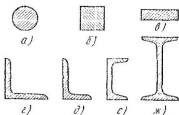
Рис. 3. Виды сортовой и фасонной прокатной стали:
