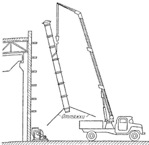
Рис. 127. Монтаж вертикальных воздухопроводов по наружной стене здания автомобильным краном
