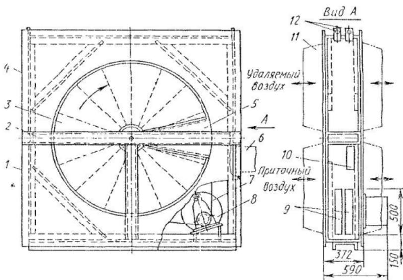
Рис. 25. Регенеративный вращающийся теплоутилизатор типа ТП.10-Э2РГ.01:
