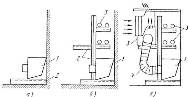
Рис. 113. Последовательность монтажа (а—в) эжекционного доводчика:
