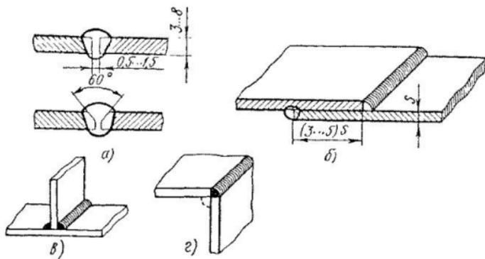
Рис. 91. Сварные соединения:
