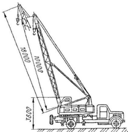
Рис. 72. Автомобильный кран
