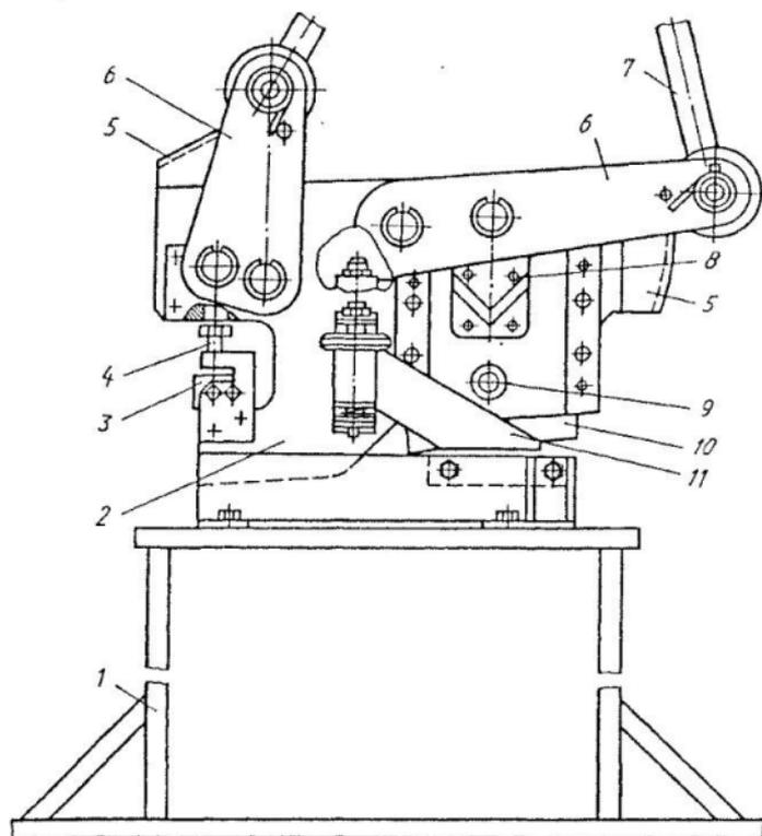
Рис. 77. Комбинированные ножницы для вентиляционных работ СТД-53005:
