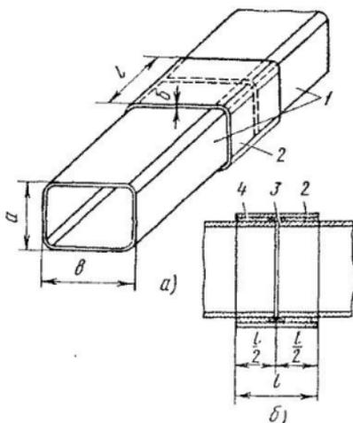
Рис. 136. Муфтовое соединение асбестоцементного короба:
