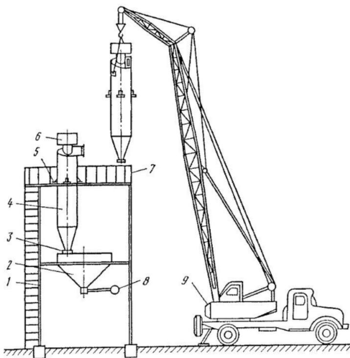
Рис. 116. Монтаж циклона:
