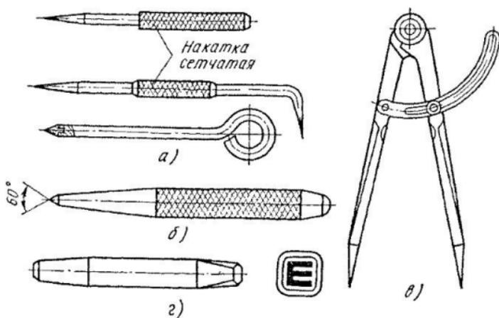
Рис. 76. Разметочные инструменты:
