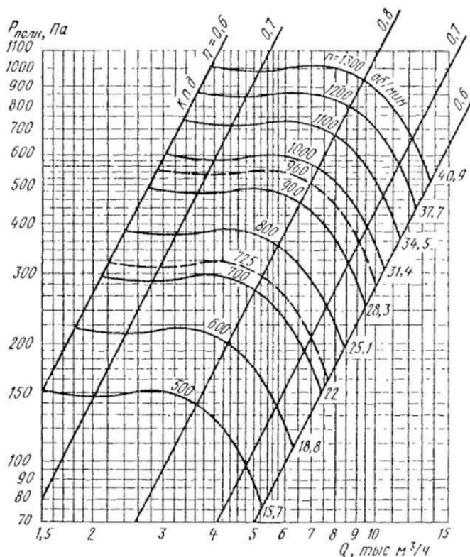
Рис. 4. Аэродинамическая характеристика вентилятора среднего давления
