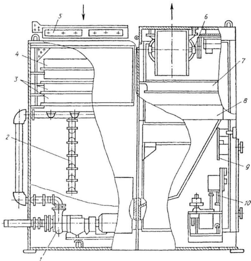
Рис. 22. Схема неавтономного кондиционера КТН-3,15-01:
