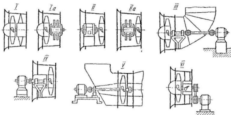
Рис. 12. Схемы конструктивных исполнений (I...VI) осевых вентиляторов
