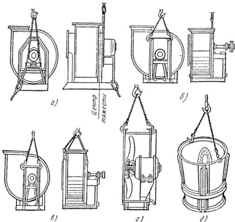
Рис. 97. Строповка вентиляторов:
