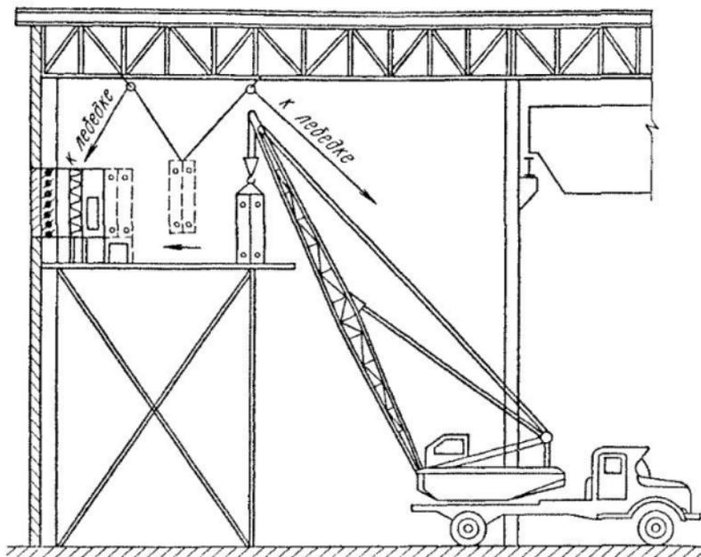
Рис. 114. Монтаж воздухонагревательного блока автомобильным краном и лебедками
