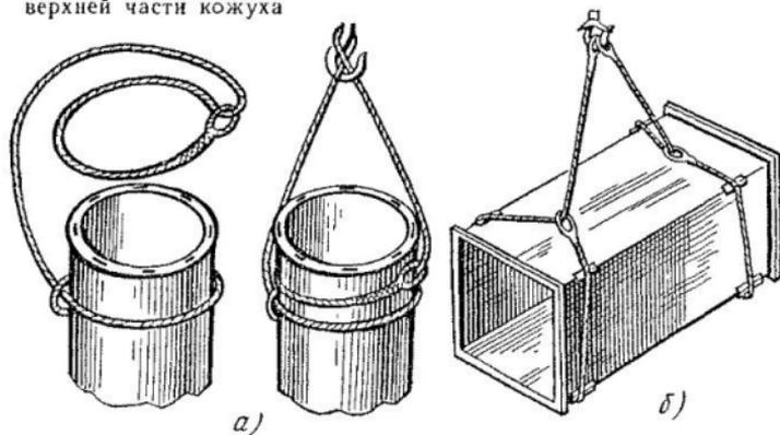
Рис. 100. Строповка воздуховодов:
