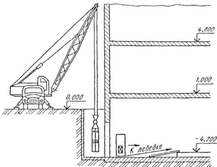
Рис. 107. Монтаж секций кондиционера автомобильным краном через монтажный проем
