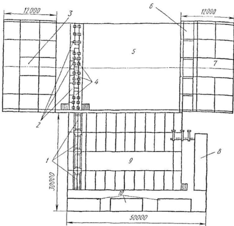
Рис. 132. План стоянки производства вентиляционных работ при конвейерной сборке блоков покрытий:
