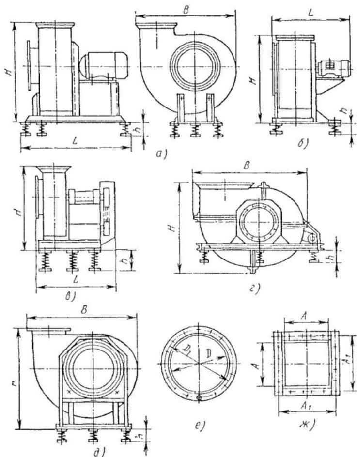
Рис. 8. Схемы вентиляторных агрегатов с вентиляторами:
