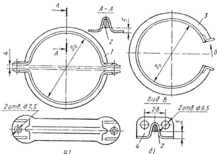
Рис. 48. Бандажи для соединения деталей круглых воздухопроводов:
