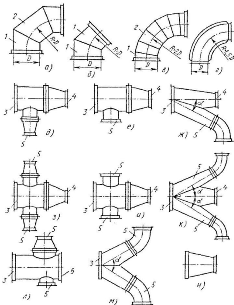
Рис. 27. Фасонные части круглых воздуховодов:
