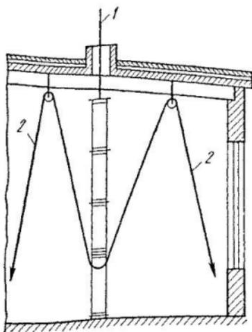
Рис. 128. Монтаж вертикального воздуховода методом выдавливания:
