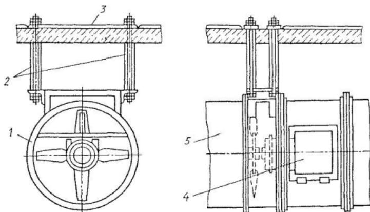
Рис. 104. Установка осевого вентилятора в воздуховоде:
