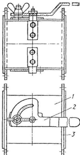
Рис. 37. Стальной неутепленный дроссель-клапан для воздуховодов:
