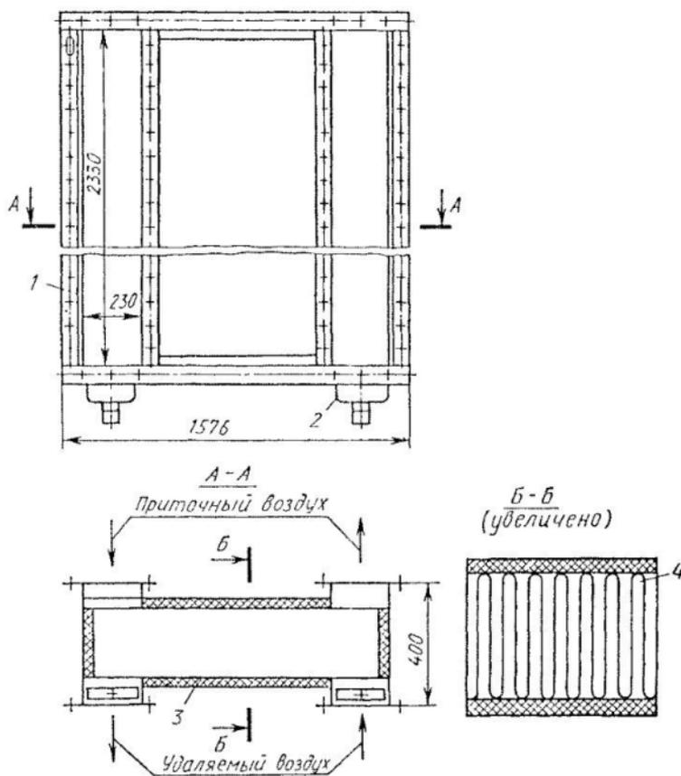
Рис. 26. Рекуперативный пластинчатый теплоутилизатор типа ТП.05-Т2:
