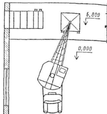
Рис. 108. Монтаж секций кондиционера автопогрузчиком
