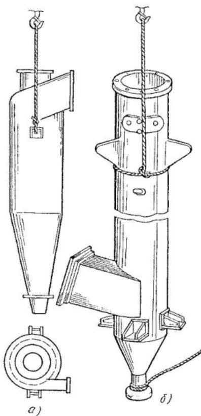
Рис. 99. Строповка циклона (*a*) и скруббера (*б*)
