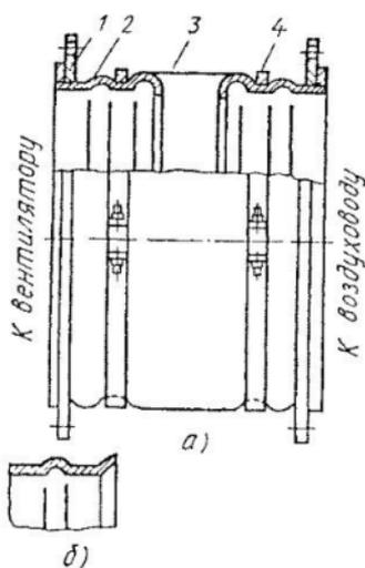
Рис. 49. Гибкая вставка (*а*) и вариант обрамления конца вставки под бандажное соединение (*б*):
