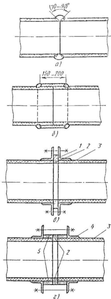
Рис. 135. Соединения винипластовых воздухопроводов с помощью:
