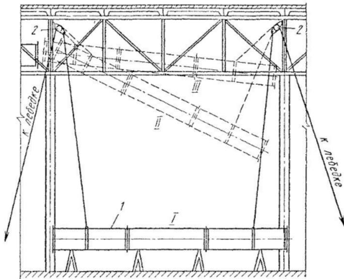
Рис. 120. Монтаж воздуховодов в межферменном пространстве двумя лебедками:
