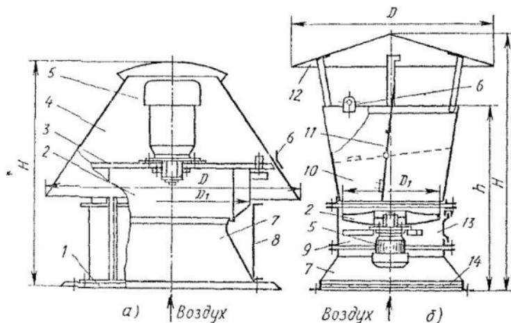
Рис. 15. Крышные вентиляторы:
