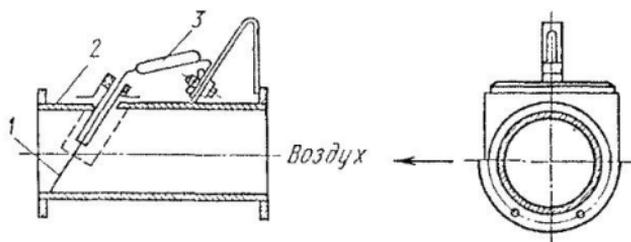
Рис. 38. Стальной неутепленный шибер:
