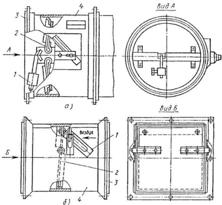
Рис. 39. Обратный клапан круглого (а) и прямоугольного (б) сечений:
