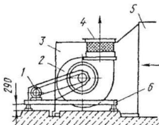
Рис. 111. Приточная камера кондиционера КТЦ2-250 с вентилятором двустороннего всасывания:
