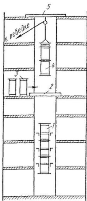
Рис. 125. Монтаж вертикальных воздухопроводов методом наращивания сверху:
