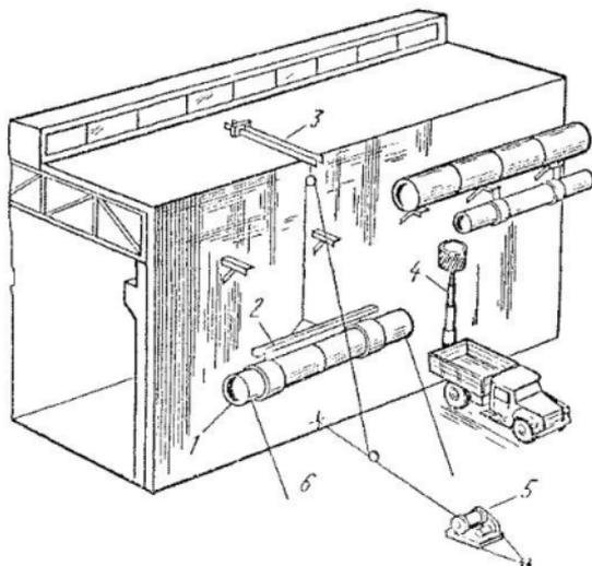
Рис. 123. Монтаж горизонтальных воздуховодов по наружным стенам:
