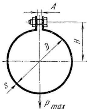
Рис. 50. Хомут для крепления круглых воздуховодов
