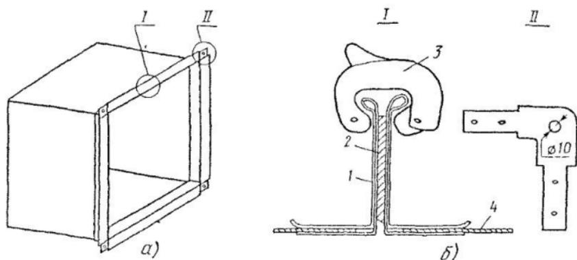
Рис. 86. Соединение деталей прямоугольных воздуховодов на шинах:
