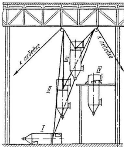
Рис. 117. Монтаж скруббера (I...IV — последовательность монтажа)
