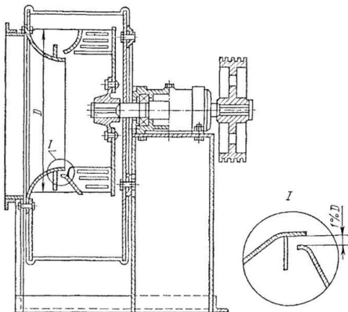
Рис. 102. Выверка зазоров при сборке вентилятора
