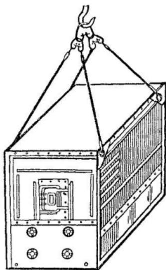
Рис. 96. Строповка наружной камеры кондиционера
