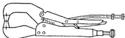
Рис. 79. Фиксаторные клещи СТД-153
