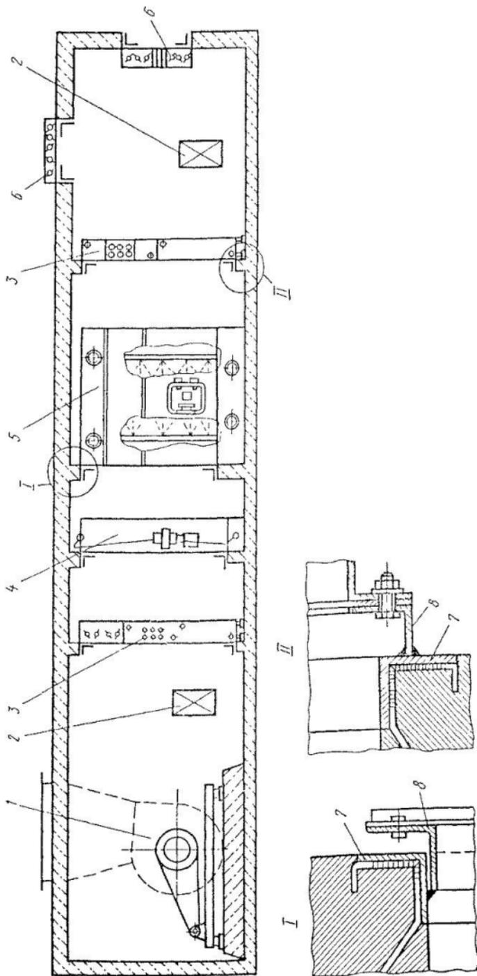
Рис. 112. Центральный кондиционер в строительном исполнении:
