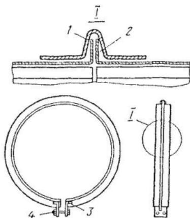
Рис. 85. Бандажное соединение воздуховодов:
