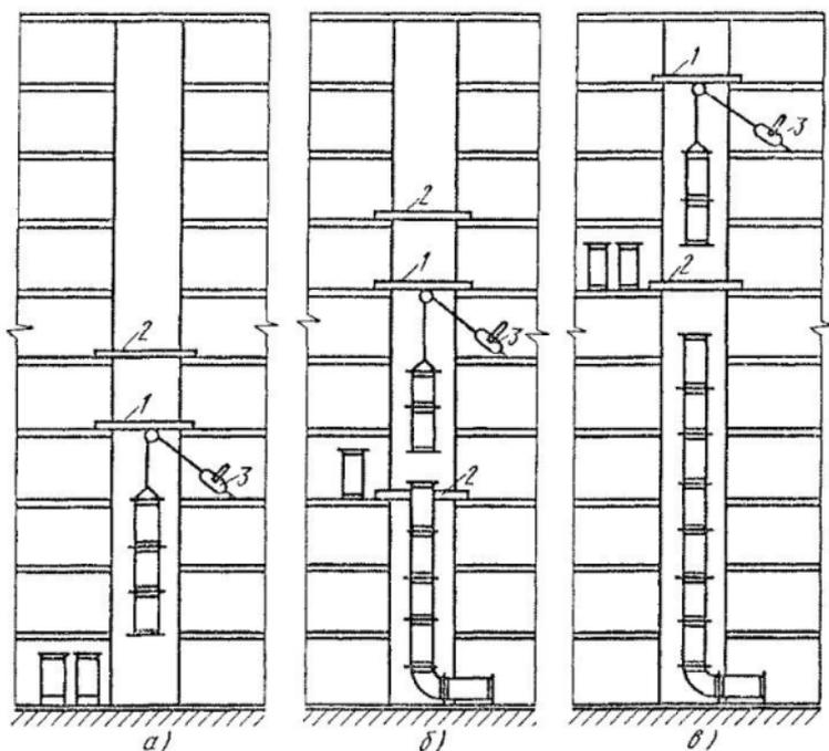
Рис. 126. Последовательность (а...в) монтажа вертикальных воздухопроводов комбинированным методом:
