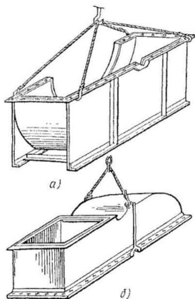
Рис. 98. Строповка вентиляторов № 16 и № 20:
