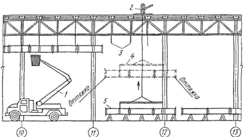
Рис. 119. Монтаж горизонтальных воздуховодов укрупненными звеньями:
