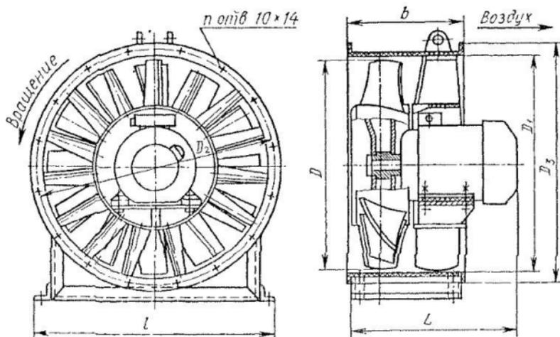
Рис. 14. Схема осевого вентилятора В-2,3-130 № 8...12,5
