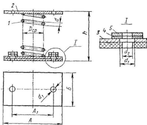
Рис. 52. Пружинные виброизоляторы типа ДО:
