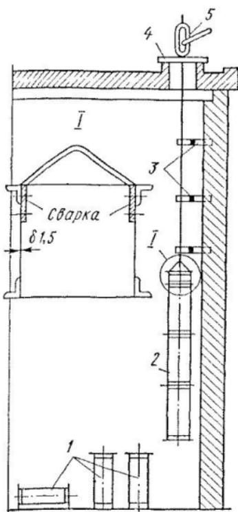
Рис. 124. Монтаж вертикальных воздухопроводов методом наращивания снизу:
