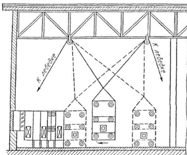
Рис. 110. Монтаж секций кондиционера с помощью лебедок
