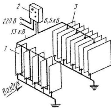
Рис. 19. Схема электрофильтра ФЭ:
