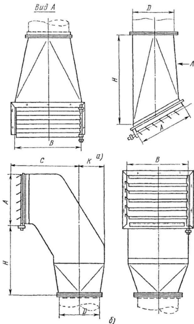
Рис. 34. Душирующие патрубки ПДв (а) и ПДн (б)
