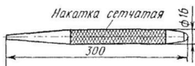
Рис. 80. Удлиненная оправка СТД-931/2
