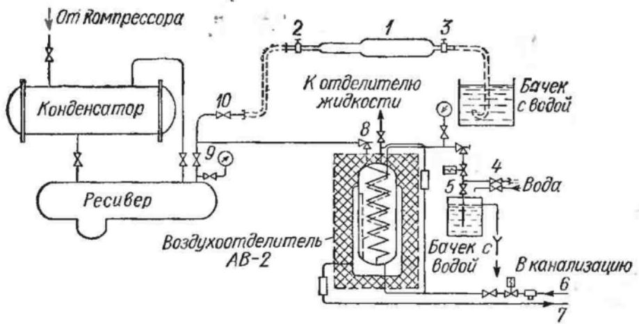
Рис. 61. Схема включения воздухоотделителя АВ-2
