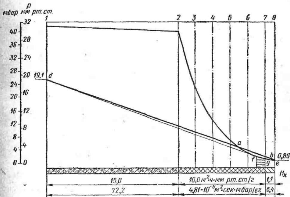
Рис. 7. Установление зоны конденсации в ограждении
