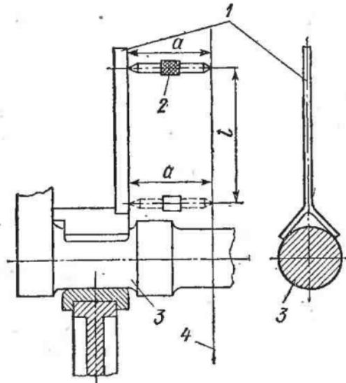
Рис. 50. Проверка перпендикулярности оси цилиндра к оси коленчатого вала с помощью валового угольника и микроштихмаса:
