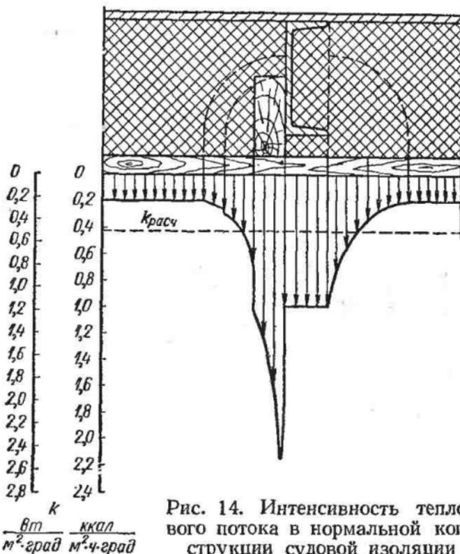
Рис. 14. Интенсивность теплового потока в нормальной конструкции судовой изоляции
