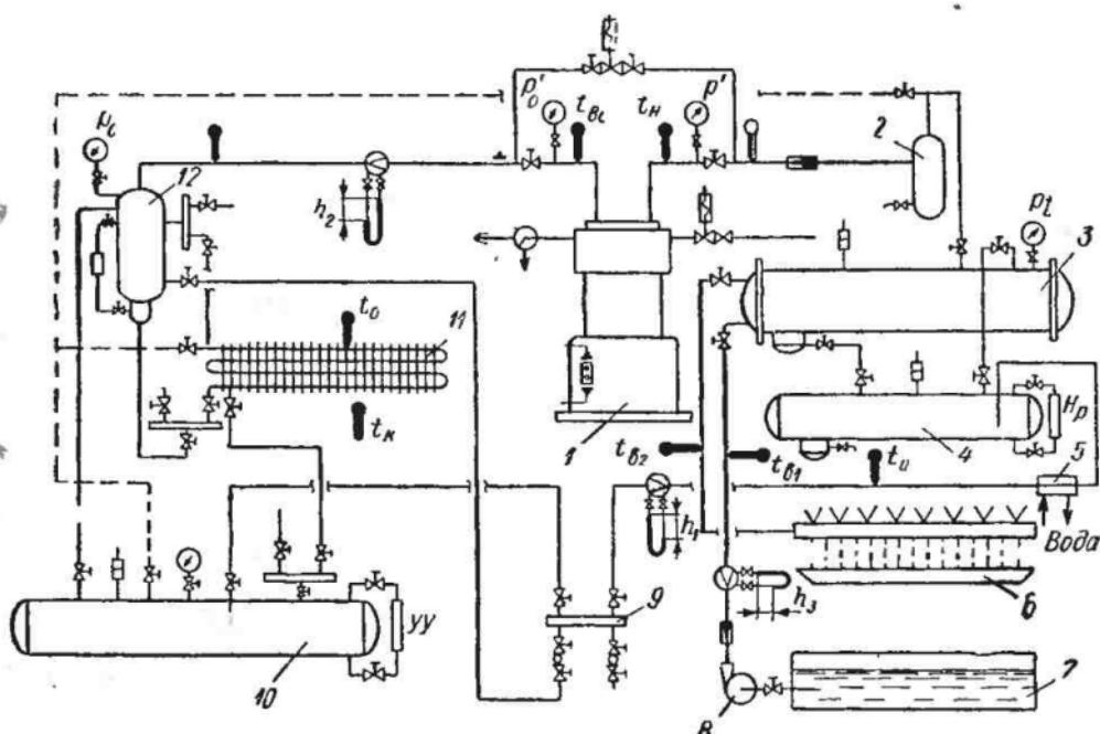
Рис. 57. Принципиальная схема лабораторной аммиачной холодильной установки
