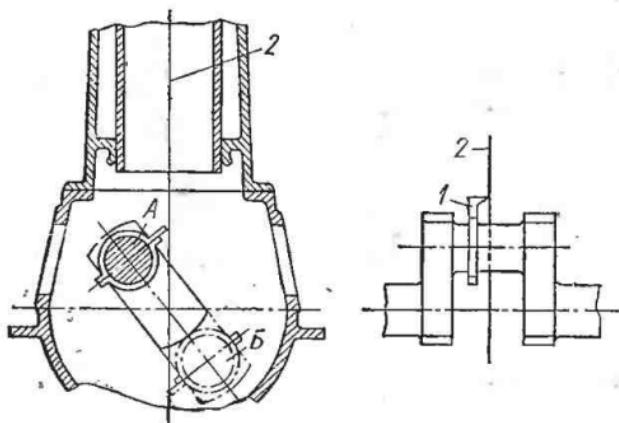
Рис. 51. Схема проверки перпендикулярности осей цилиндра к оси коленчатого вала
