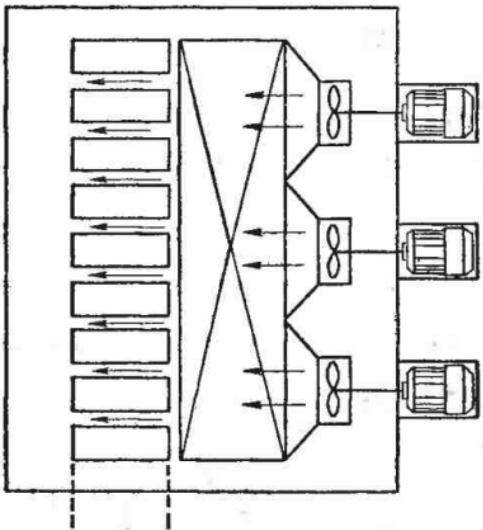
Рис. 25. Скороморозильный аппарат непрерывного действия: а — схема аппарата с продольным движением воздуха; б — схема аппарата с поперечным движением воздуха
