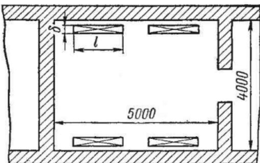
Рис. 33. План камеры с льдосоляным охлаждением
