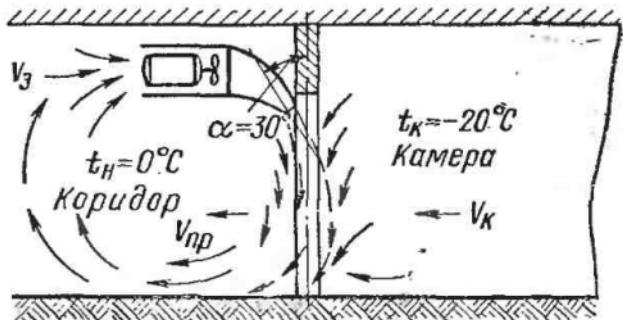
Рис. 19. Схема воздушной завесы у двери холодильной камеры
