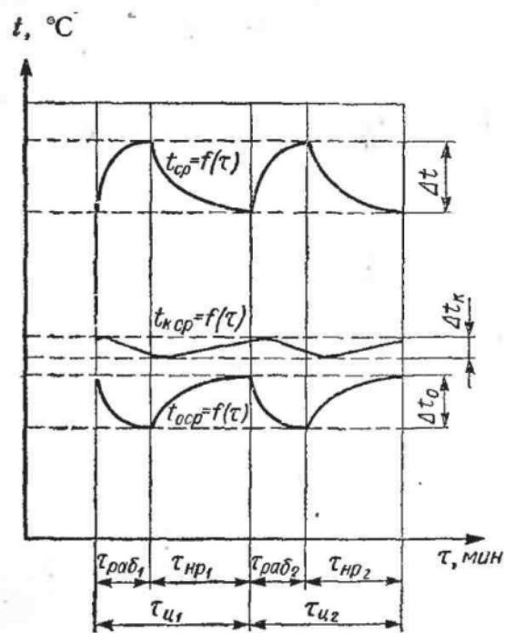
Рис. 68. Графики изменения температуры воздуха внутри шкафа и температур на поверхностях аппаратов
