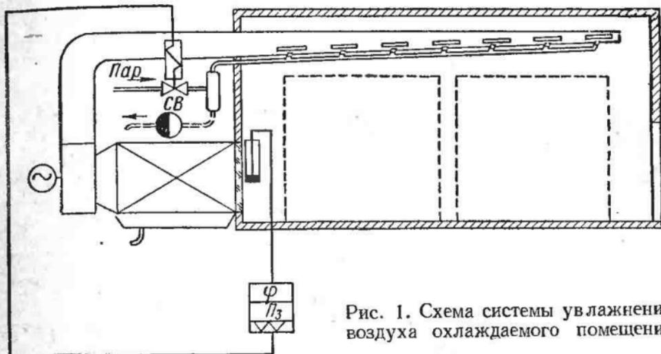
Рис. 1. Схема системы увлажнения воздуха охлаждаемого помещения
