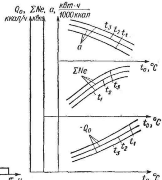
Рис. 59. Характеристики работы холодильной установки при различных температурных режимах
