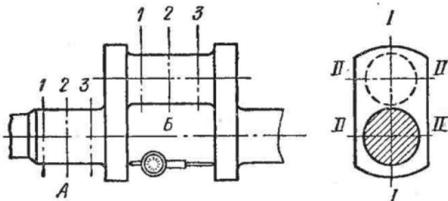
Рис. 71. Определение износа шеек коленчатого вала
