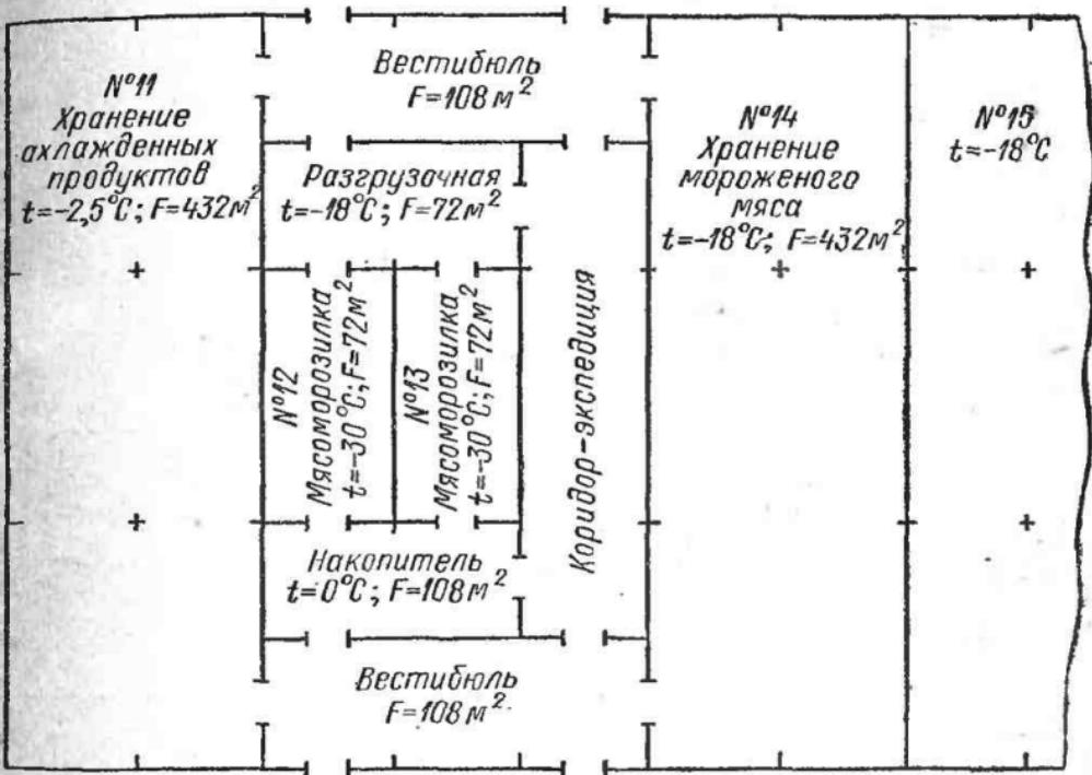
Рис. 15. План части помещений холодильника, рассчитываемых в задаче
