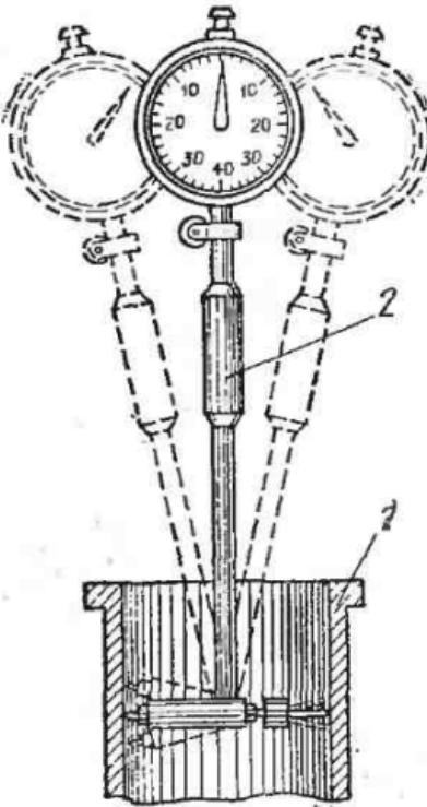
Рис. 74. Измерение диаметра цилиндра с помощью индикатора:
