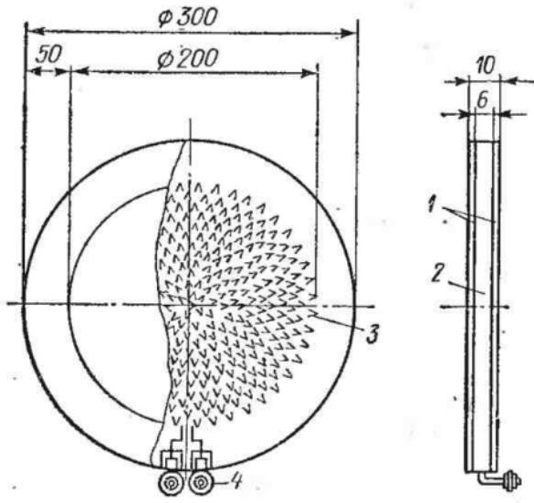
Рис. 38. Измеритель малых тепловых потоков конструкции ЛТИХП
