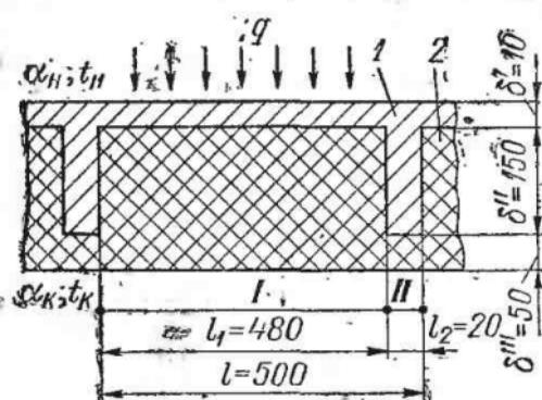
Рис. 10. Изолированное ограждение с металлическими тепловыми мостиками:
