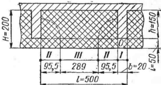
Рис. 11. Расчетные зоны в ограждении с металлическими тепловыми мостиками
