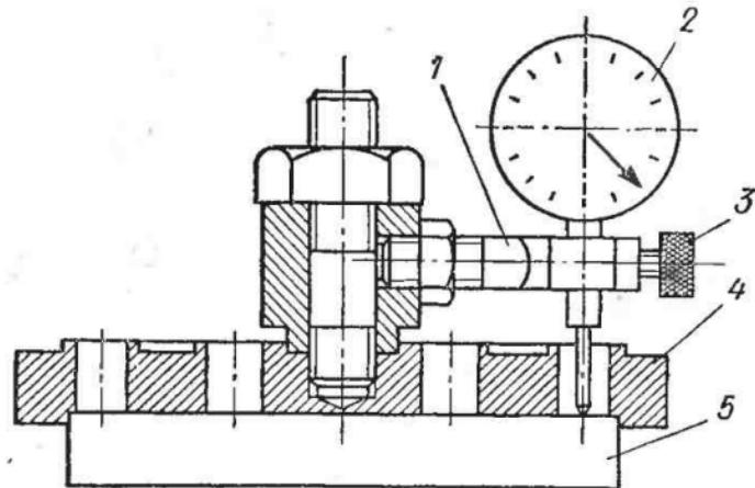
Рис. 76. Приспособление для измерения линейного вредного пространства, установленного на шлифованной шайбе:
