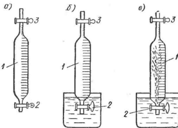
Рис. 62. Прибор для определения содержания неконденсирующихся газов: *а* — пипетка Зегера; *б* — пипетка Зегера, опущенная в сосуд с водным раствором серной кислоты; *в* — процесс поглощения раствором паров аммиака, находящихся во взятой пробе
