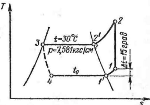
Рис. 2. Цикл холодильной машины в диаграмме  $s - T$
