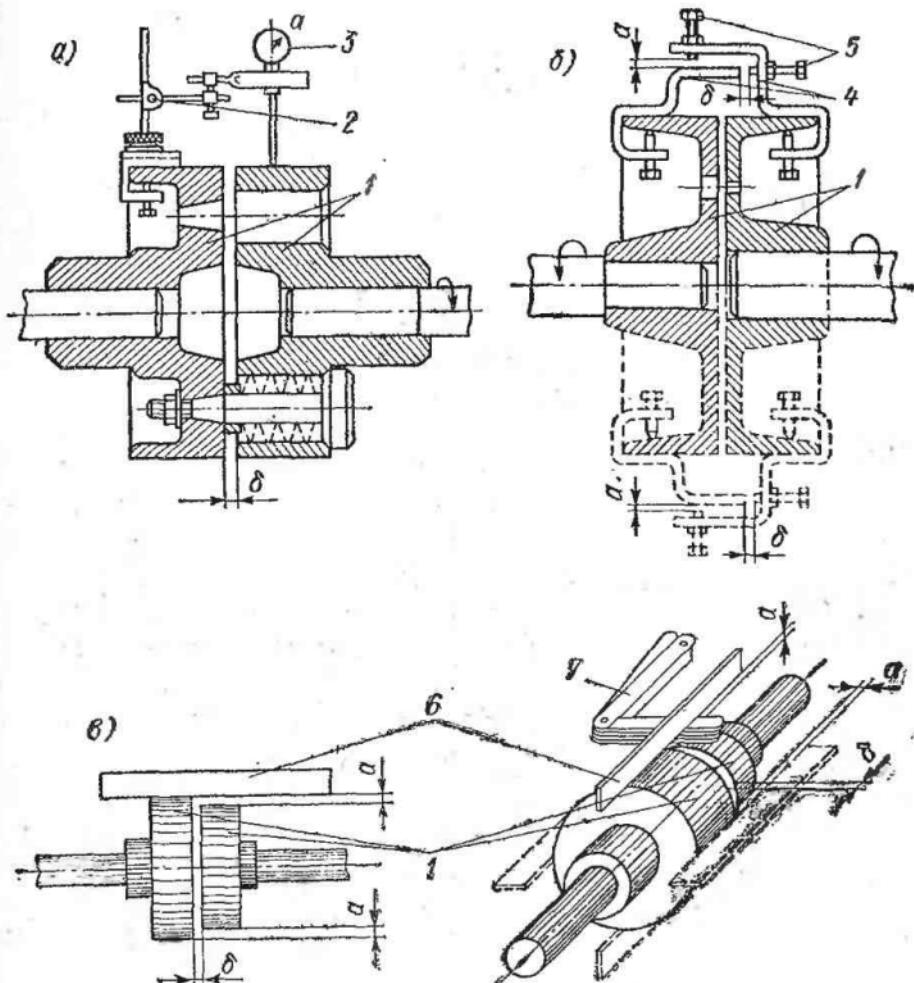
Рис. 55. Схема проверки центровки валов (а — при помощи индикатора; б — с помощью скоб и щупа; в — при помощи линейки и щупа):
