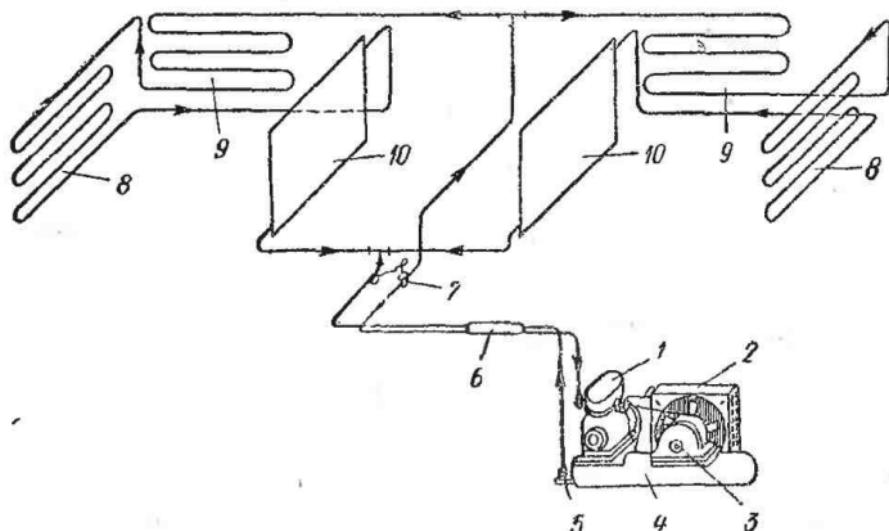
Рис. 70. Схема холодильной установки в низкотемпературной витрине П-ЗМ:
