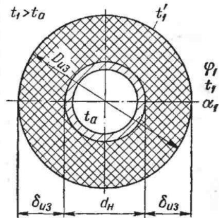
Рис. 8. Изоляция холодного трубопровода
