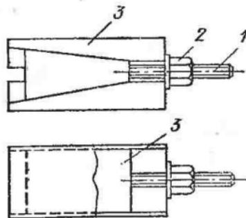
Рис. 42. Клины, перемещаемые винтовым устройством (клиновой домкрат):
