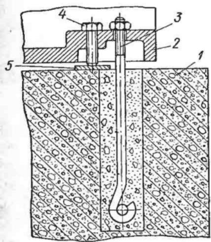
Рис. 43. Отжимной регулирующий болт:
