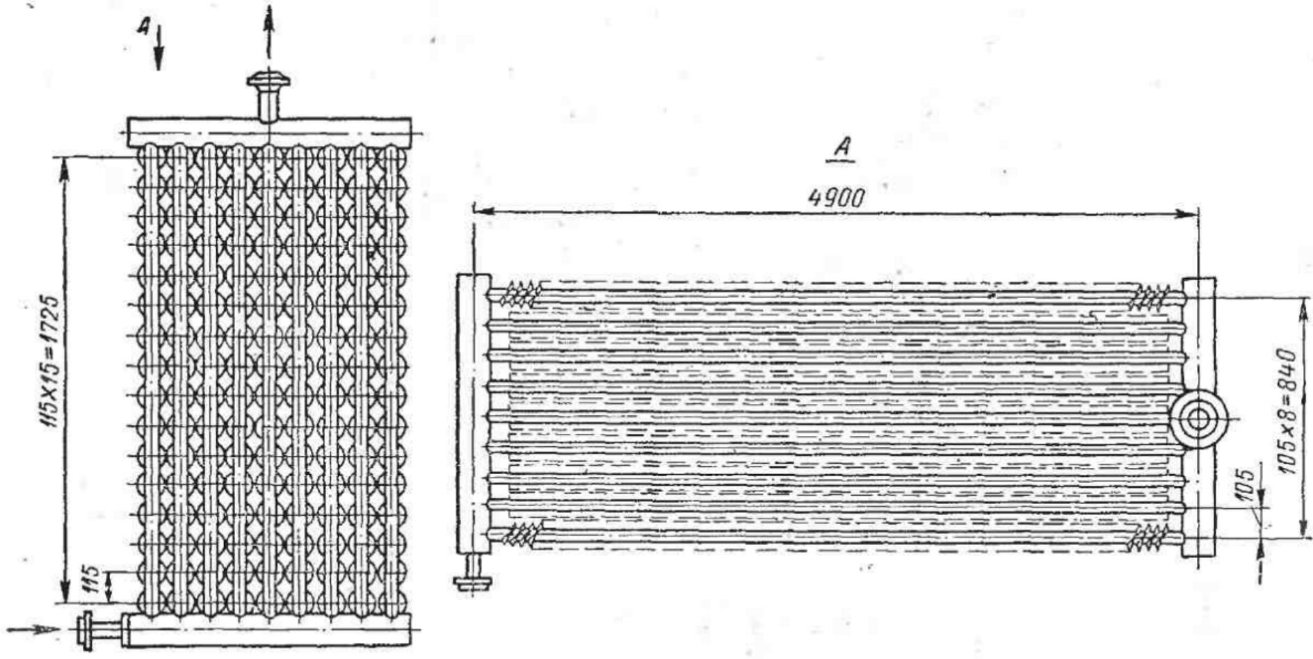
Рис. 24. Батарея воздухоохладителя для морозилки
