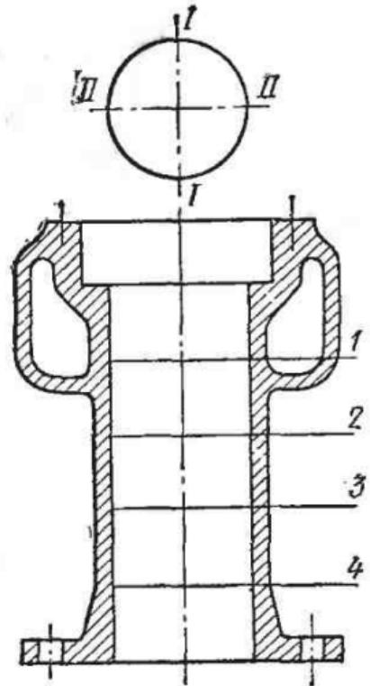
Рис. 72. Определение износа цилиндра компрессора
