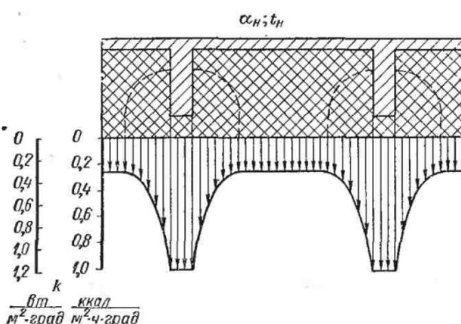
Рис. 12. Интенсивность теплового потока в ограждении с металлическими тепловыми мостиками
