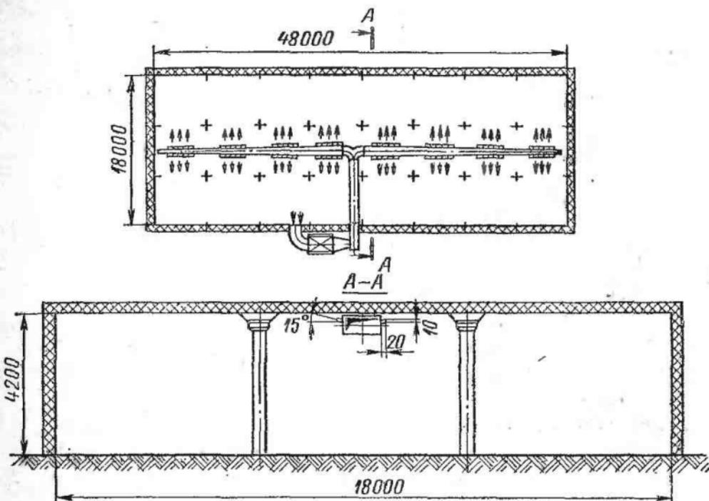
Рис. 18. Камера холодильника с одноканальным воздухораспределением
