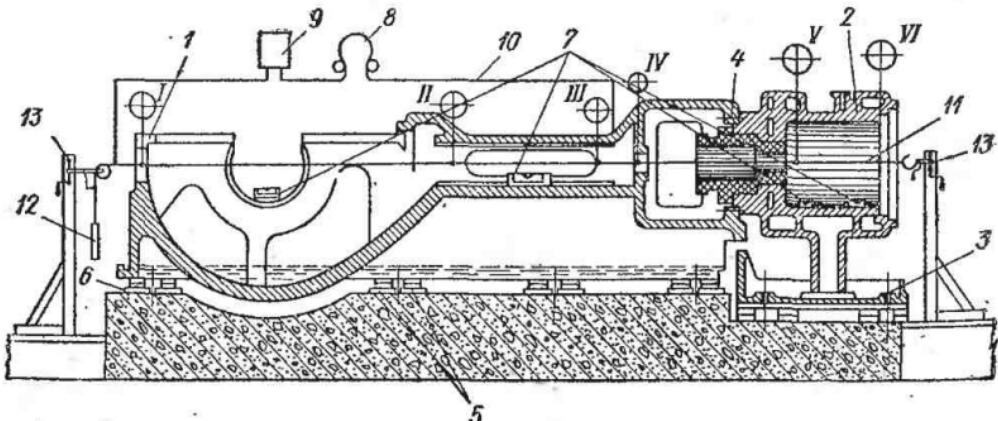
Рис. 46. Схема установки рамы компрессора на фундамент и проверки ее на горизонтальность и по осям:
