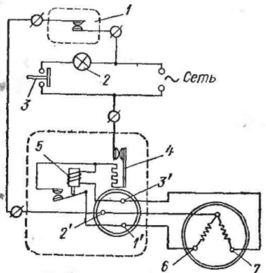
Рис. 65. Электрическая схема домашнего холодильника
