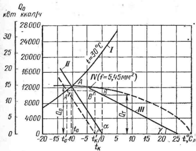
Рис. 3. Характеристики холодильной машины и охлаждаемого помещения
