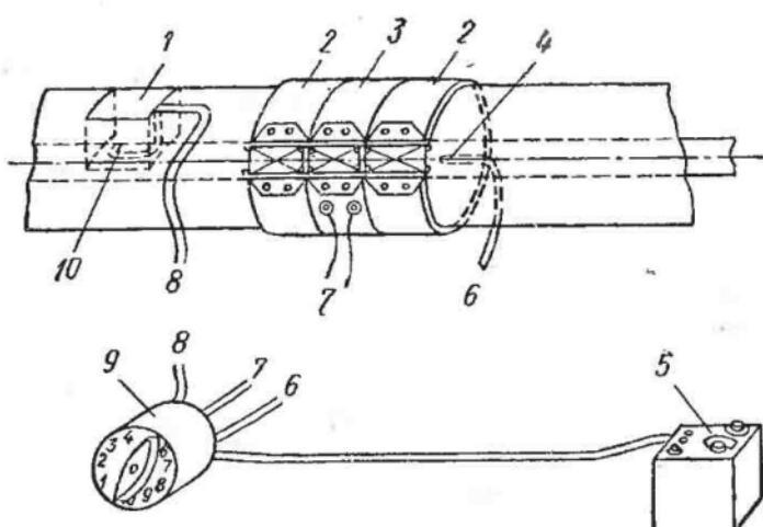
Рис. 39. Схема лабораторной установки для определения коэффициента теплопроводности теплоизоляции холодного трубопровода:
