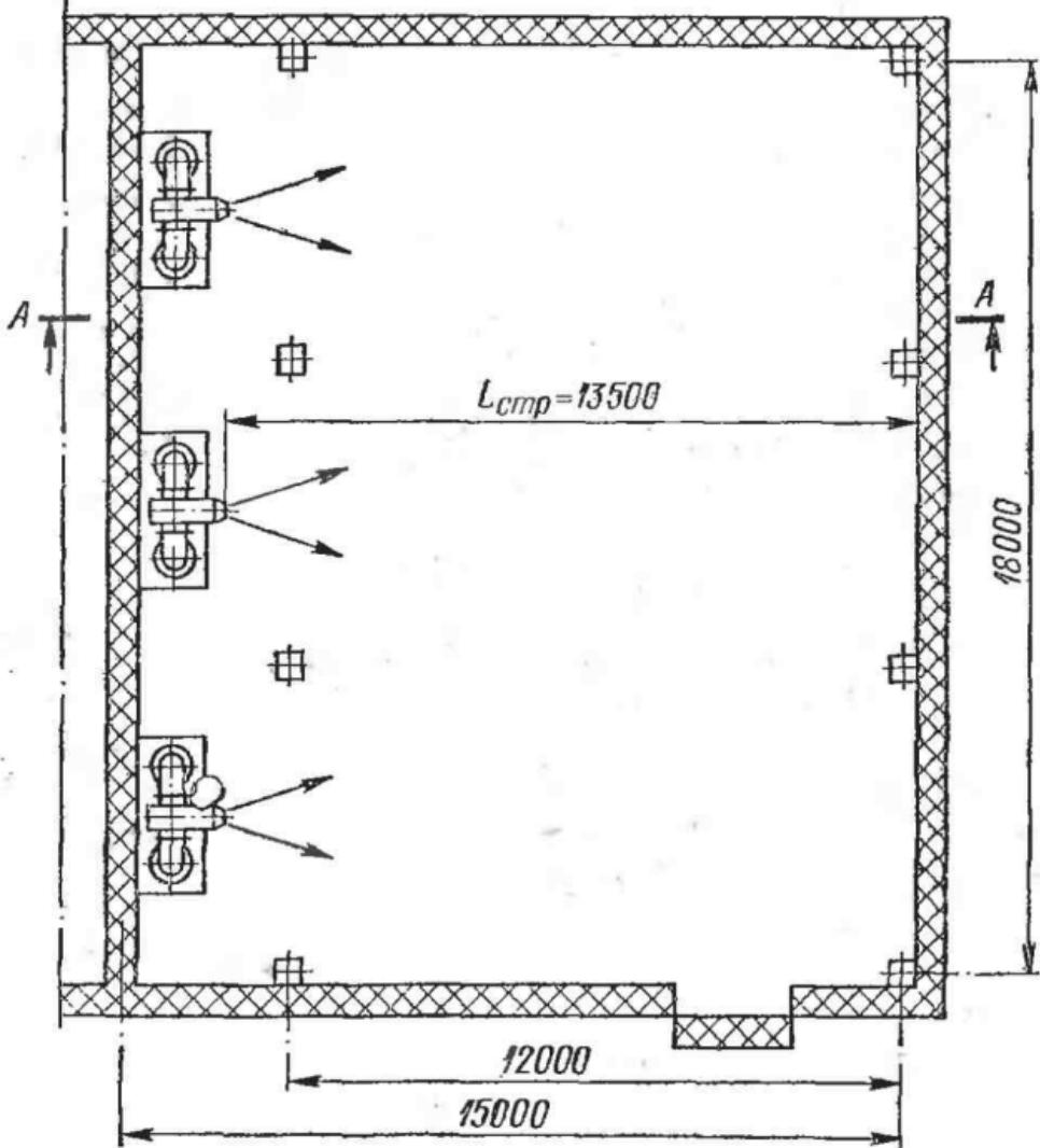
Рис. 17. Камера холодильника с бесканальным воздухораспределением
