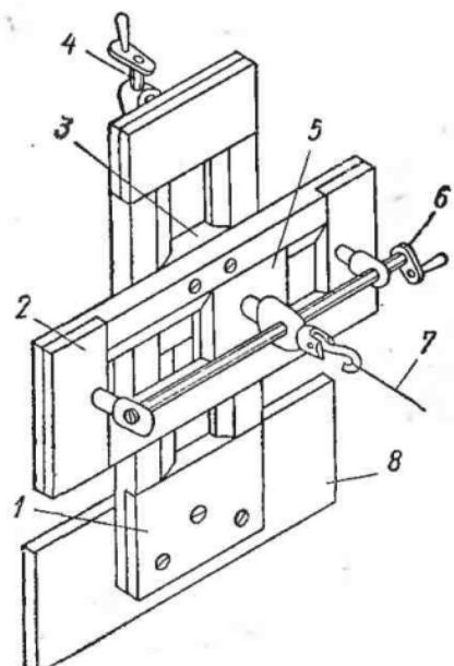
Рис. 47. Приспособление для центровки струны (монтажной каретки):
