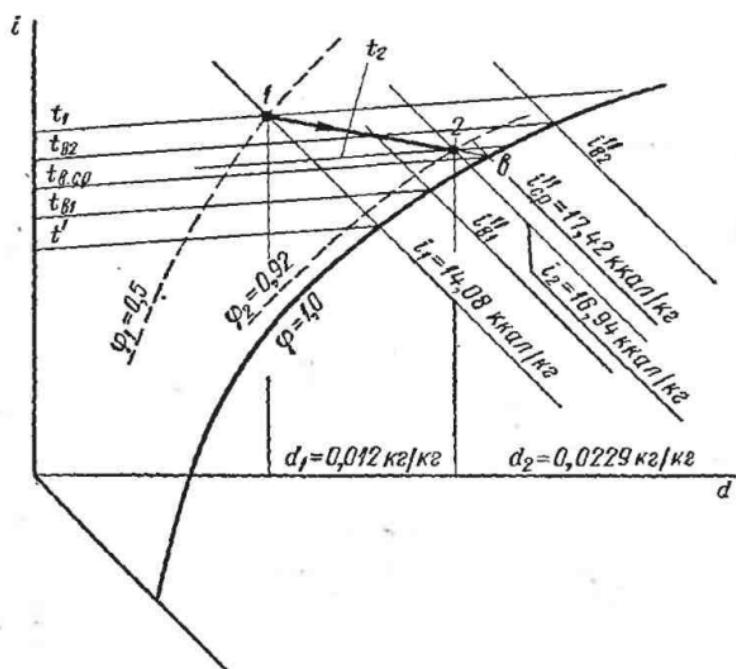
Рис. 31. Изменение состояния воздуха при прохождении через градирню
