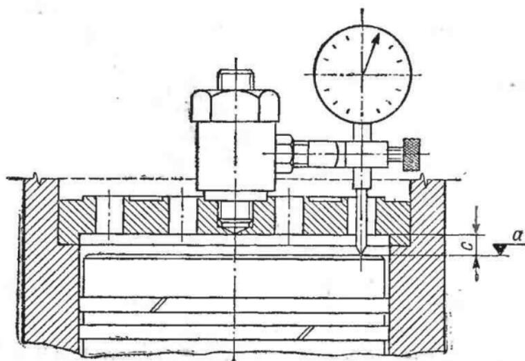
Рис. 77. Приспособление для измерения линейного вредного пространства, установленное на цилиндре компрессора: *a* — верхняя мертвоточка; *c* — линейное вредное пространство
