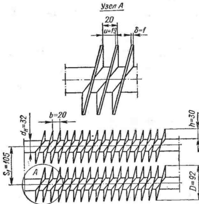
Рис. 23. Оребренные трубы воздухоохладителя
