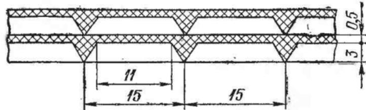
Рис. 30. Элемент регулярной насадки капиллярной градирни
