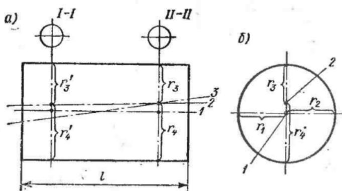
Рис. 48. Относительное расположение осей цилиндра и рамы компрессора:
