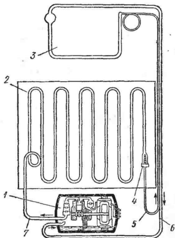
Рис. 64. Схема агрегата компрессорного домашнего холодильника
