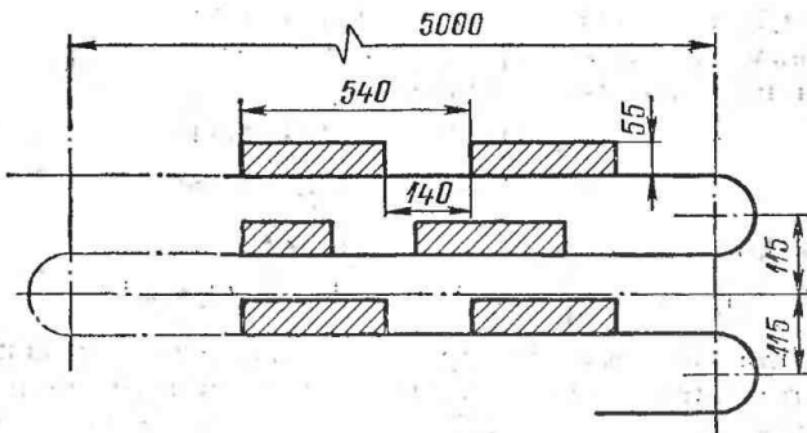
Рис. 26. Схема узла конвейера аппарата для замораживания рыбы в блоках
