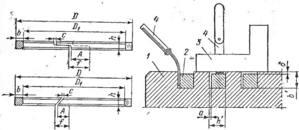
Рис. 75. Измерения зазоров в замке поршневого кольца и в сопряжении с поршневой канавкой:
