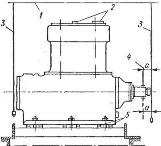
Рис. 44. Установка вертикального компрессора по осям и уровню:
