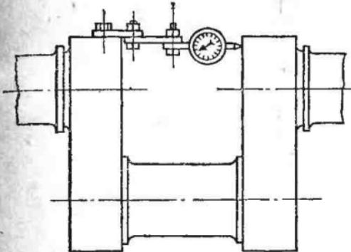
Рис. 49. Установка микроштихмаса для проверки прямолинейности укладки коленчатого вала
