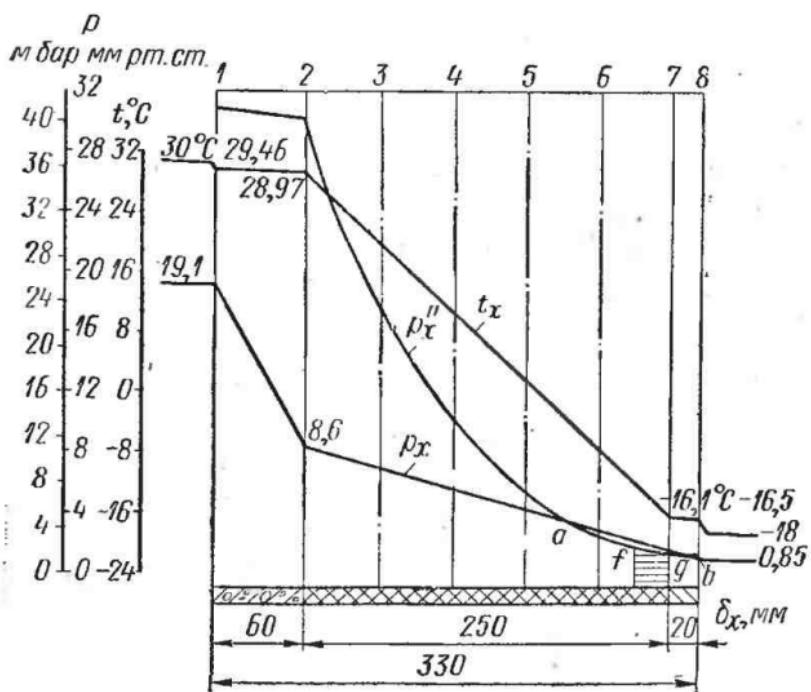
Рис. 6. Распределение температуры и давления водяного пара по слоям ограждения
