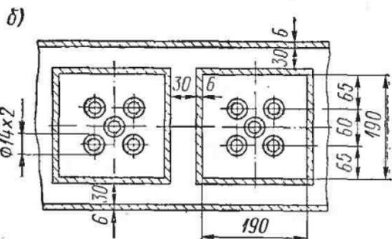
Рис. 34. Интенсивный льдогенератор блочного льда: а — размеры блока льда; б — элемент секции льдогенератора
