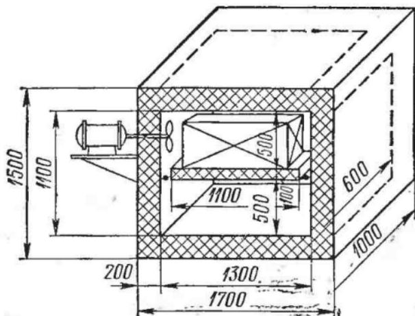
Рис. 35. Низкотемпературная камера, охлаждаемая сухим льдом
