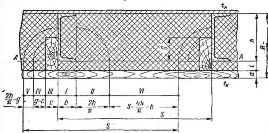
Рис. 13. Нормальная конструкция судовой изоляции
