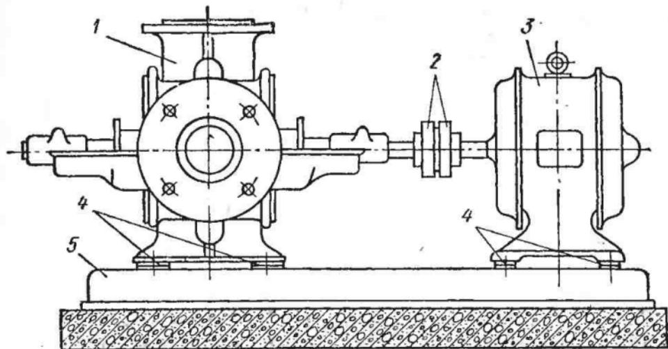
Рис. 56. Установка электродвигателя на общую раму с насосом:
