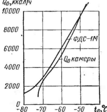
Рис. 36. Изменение теплопритоков в термобарокамеру и характеристика холодильного агрегата ФДС-1М
