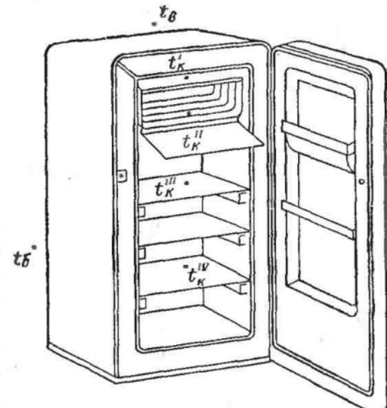
Рис. 66. Размещение термометров для измерения температур внутри шкафа и температуры окружающего воздуха
