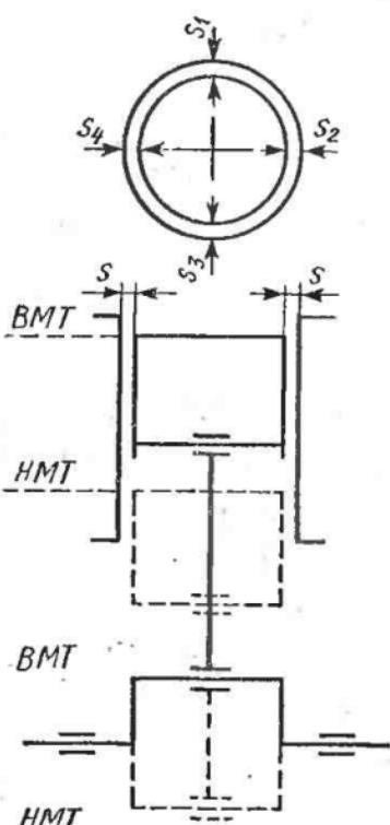
Рис. 52. Измерение радиальных зазоров между поршнем и втулкой цилиндра компрессора
