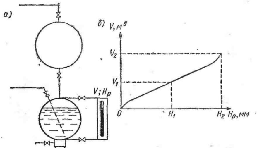
Рис. 60. Определение поправки на объем жидкости в линейном ресивере
