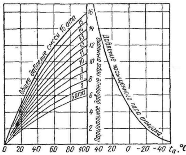
Рис. 63. Концентрация аммиака в паровоздушной смеси при различных давлениях и температурах смеси
