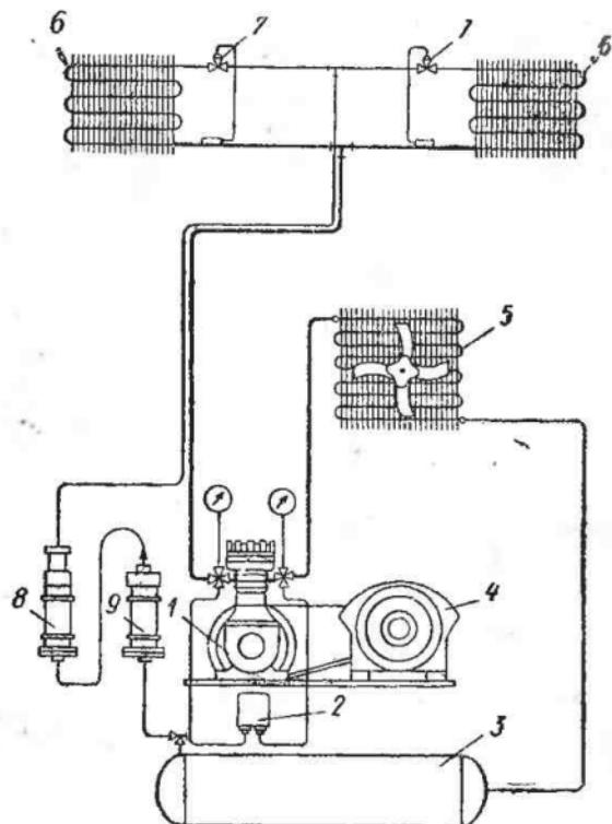
Рис. 53. Схема фреоновой холодильной установки:
