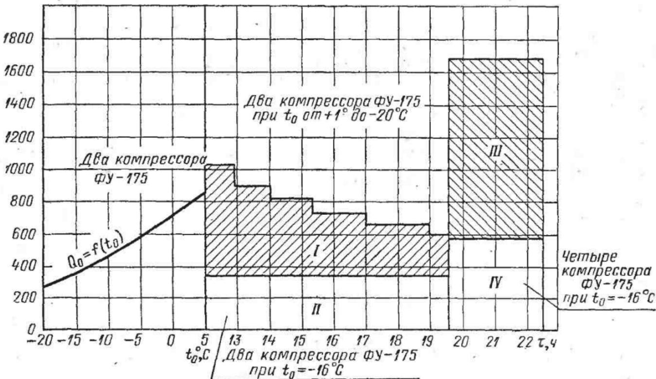
Рис. 20. Характеристика компрессоров ФУ-175 и график нагрузки на холодильное оборудование с аккумулятором холода:
