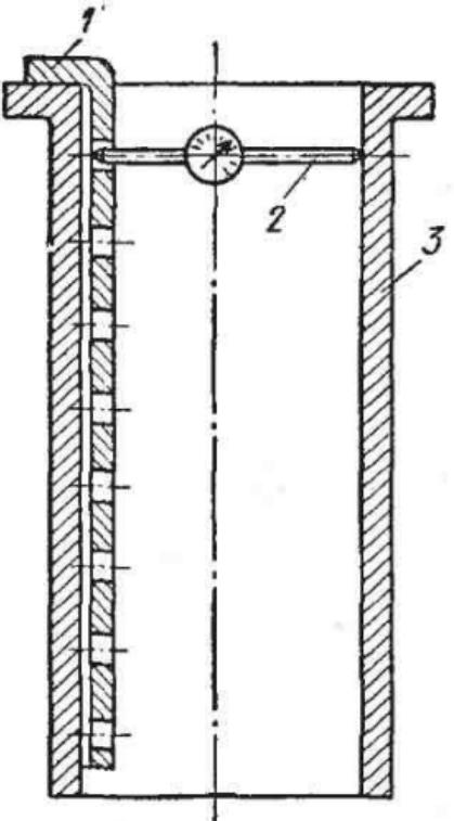
Рис. 73. Шаблон для измерения диаметра цилиндра с помощью микрометрического штихмаса:
