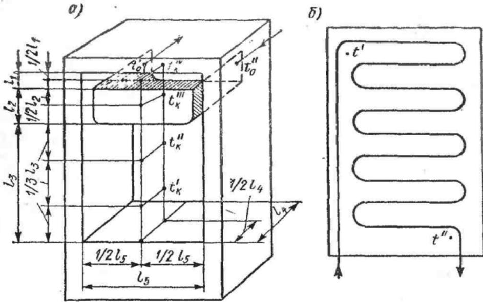
Рис. 67. Схема размещения термопар: а — внутри шкафа и на поверхности испарителя; б — на поверхности конденсатора ( $l_1$  — высота промежутка между стенками испарителя и шкафа;  $l_2$  — высота низкотемпературной камеры;  $l_3$  — высота отделения шкафа с плюсовой температурой;  $l_4$  и  $l_5$  — внутренняя ширина и длина шкафа)
