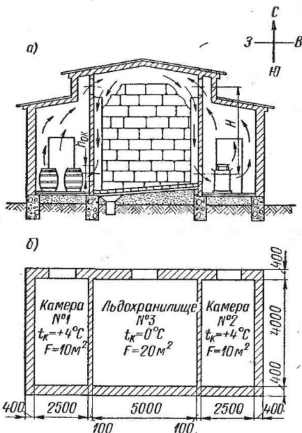
Рис. 32. Лёдник с боковым расположением льда: а — разрез; б — план ( $h_{ok}$  — высота окна)
