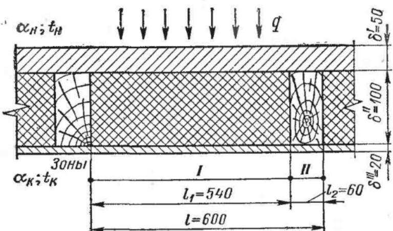
Рис. 9. Изолированное ограждение с тепловыми мостиками
