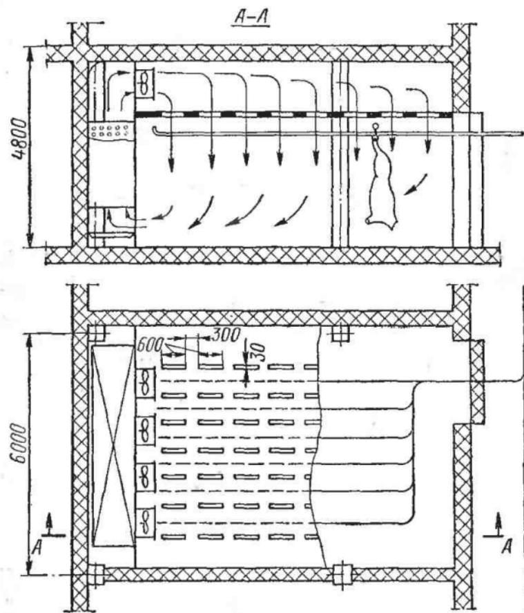
Рис. 21. Разрез и план мясоморозилки с интенсивным движением воздуха
