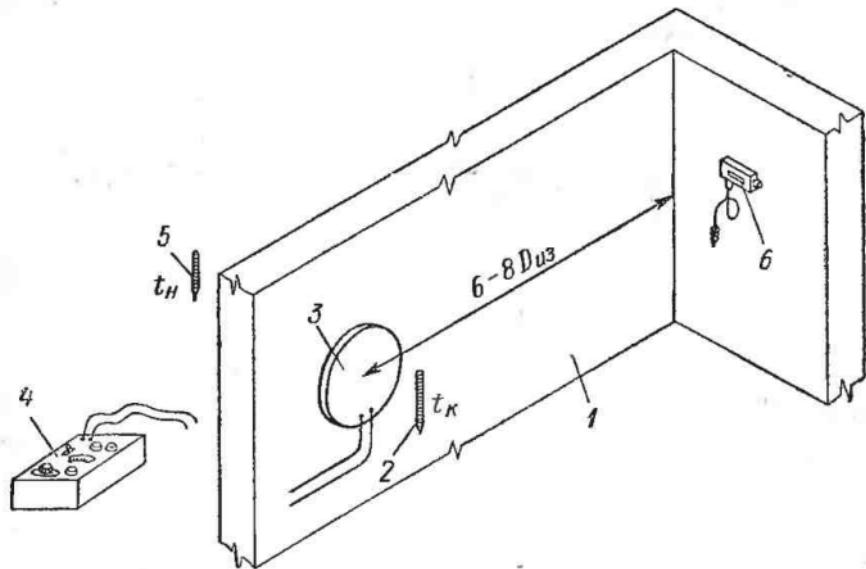
Рис. 37. Установка измерителя малых теплоизбыточных потоков на изоляционной конструкции ограждения:
