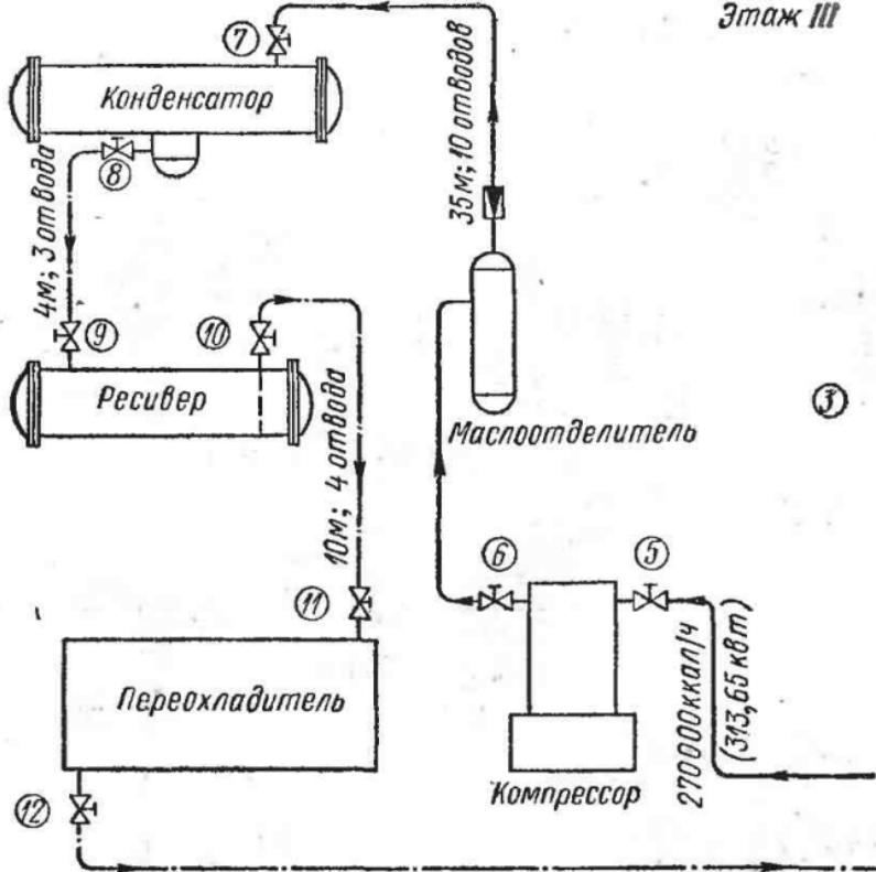
Рис. 27. Схема аммиачной установки (TPB — терморегулирующий
