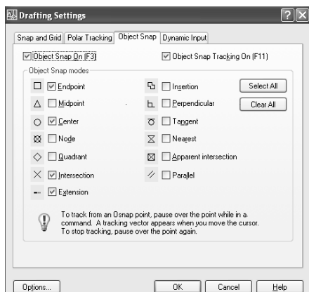
Рис. 2.14. Вкладка Object Snap диалогового окна Drafting Settings с включенными режимами привязки Endpoint и Center
