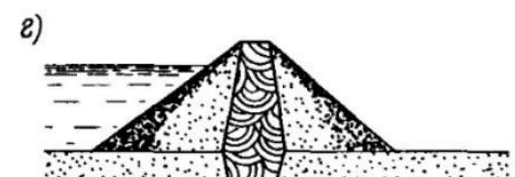
Рис. 16.31. Виды грунтовых перемычек
