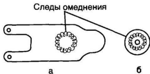
**Рис. 76. Омеднение стальных пластин клапанов:**
