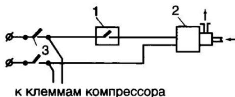
**Рис. 72. Электросхема управления водяным насосом:**
