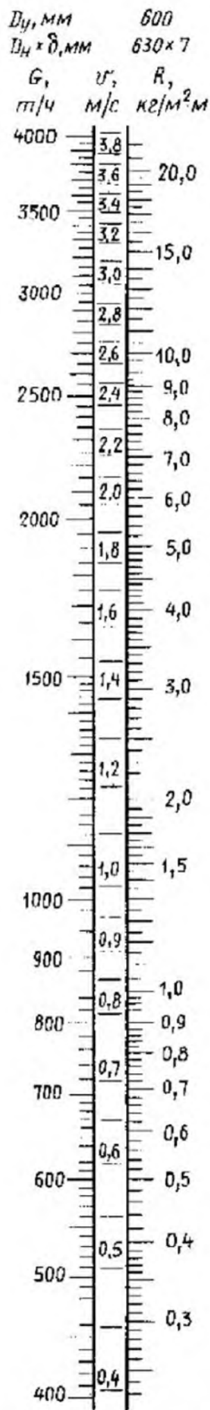
Рис. 4.32. Номограмма для расчета гидравлических потерь в водяных трубопроводах диаметром 600, 700 и 800 мм ( K=0,5 \text{ мм} , \gamma_B=958 \text{ кгс/м}^3 )
