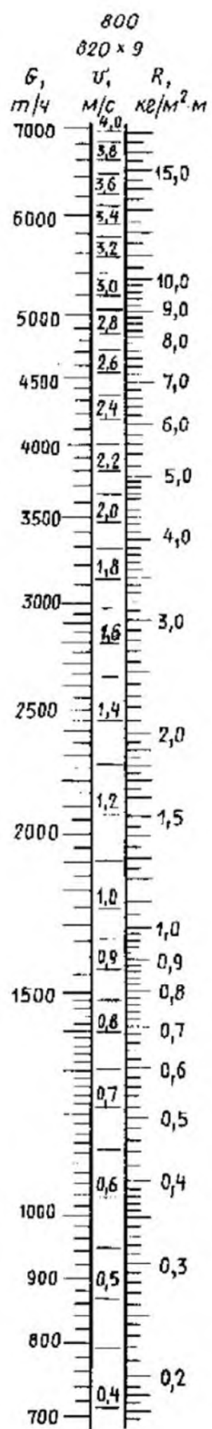
Рис. 4.32. Номограмма для расчета гидравлических потерь в водяных трубопроводах диаметром 600, 700 и 800 мм ( K=0,5 \text{ мм} , \gamma_B=958 \text{ кгс/м}^3 )
