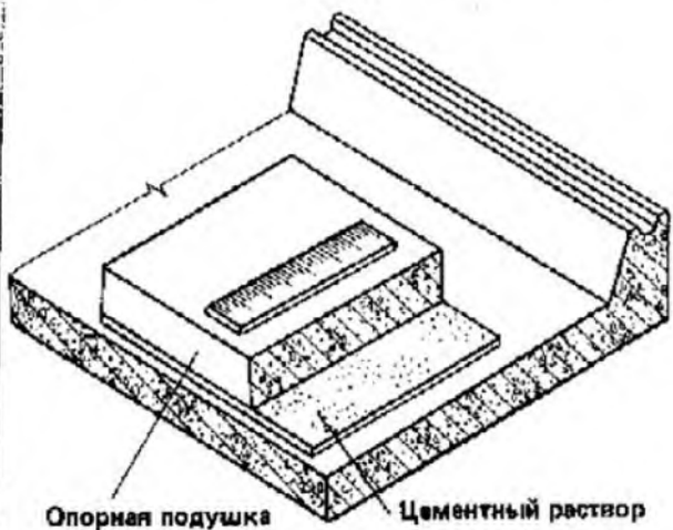
Рис. 8.18. Установка опорной подушки
