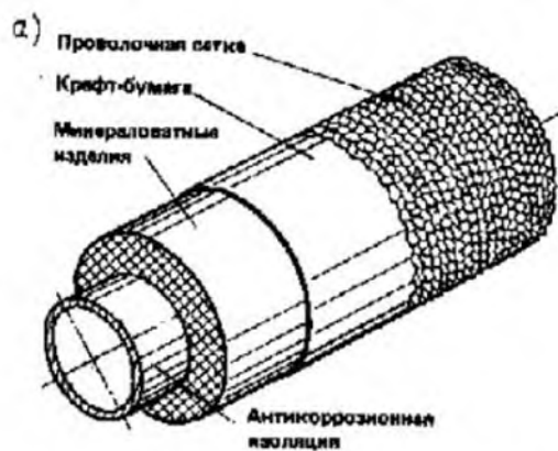
Рис. 8.24. Покрытие битумной мастикой и изолом
