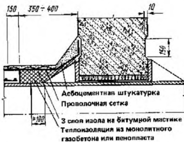
Рис. 8.30. Изоляция на стыке трубопровода и неподвижной опоры
