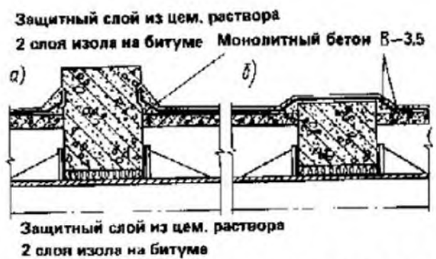
Рис. 8.33. Гидроизоляция перекрытия канала у неподвижной опоры
