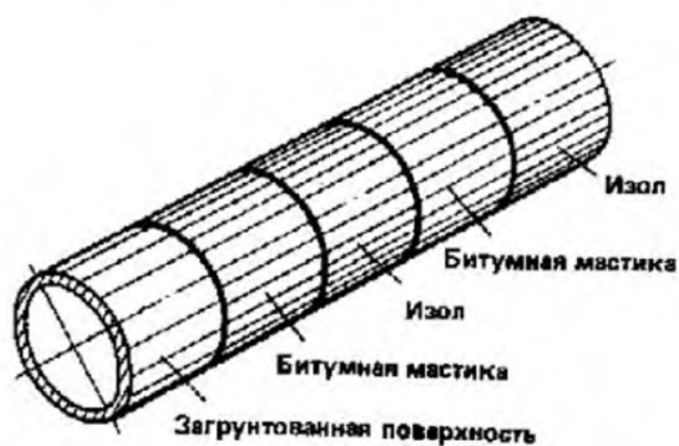
Рис. 8.24. Покрытие битумной мастикой и изолом
