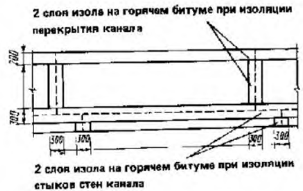
Рис. 8.32. Гидроизоляция канала при высоком уровне грунтовых вод
