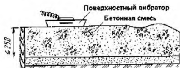
Рис. 8.11. Бетонное основание камеры
