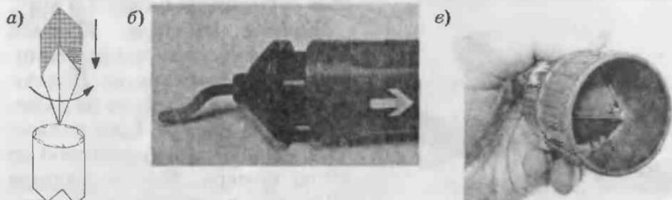
Рис. 1.4. Шаберы: а — схема использования треугольного шабера; б и в — различные конструкции шаберов
