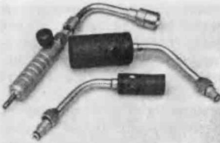
Рис. 1.25. Факельная пропановая горелка
