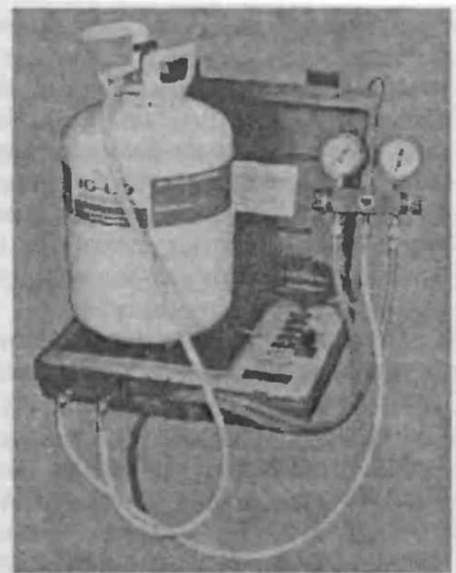
Рис. 3.4. Оборудование, готовое к заправке холодильной установки по массе
