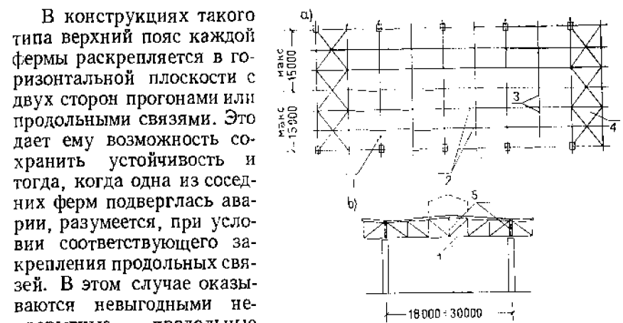
Рис. 3.80. Схема блока покрытия многопролетного цеха
