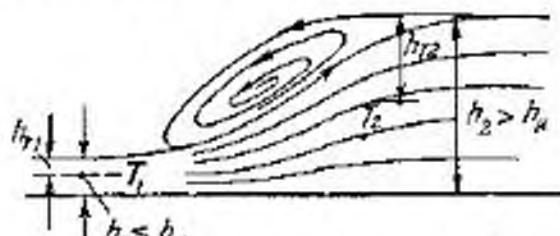
Фиг. 24-5. Поток жидкости при гидравлическом прыжке.
