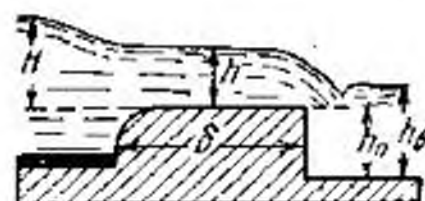
Фиг. 25-5. Водослив с широким порогом, незатопленный.
