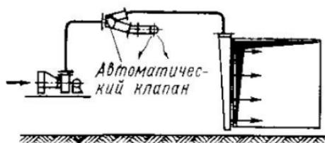
Рис. 4. Воздушно-тепловая завеса, совмещенная с воздушным отоплением
