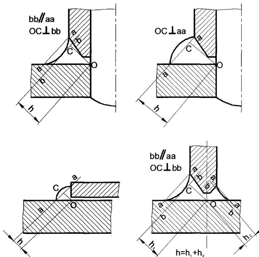
Рис. 1.3. Расчетная высота углового шва
