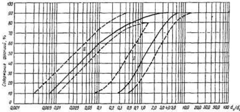
Черт. 4. График зависимости  $\alpha = f\left(\frac{d_i}{d_0}\right)$ . Гравийные плотины с ядром высотой менее 30 м
