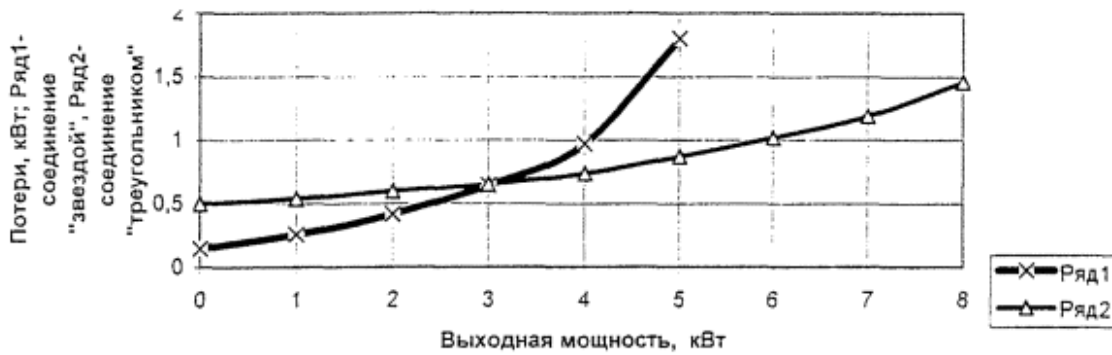
Рис. 3. Влияние на потери переключения из «треугольника» в «звезду» стандартного двигателя мощностью 7,5 кВт.
