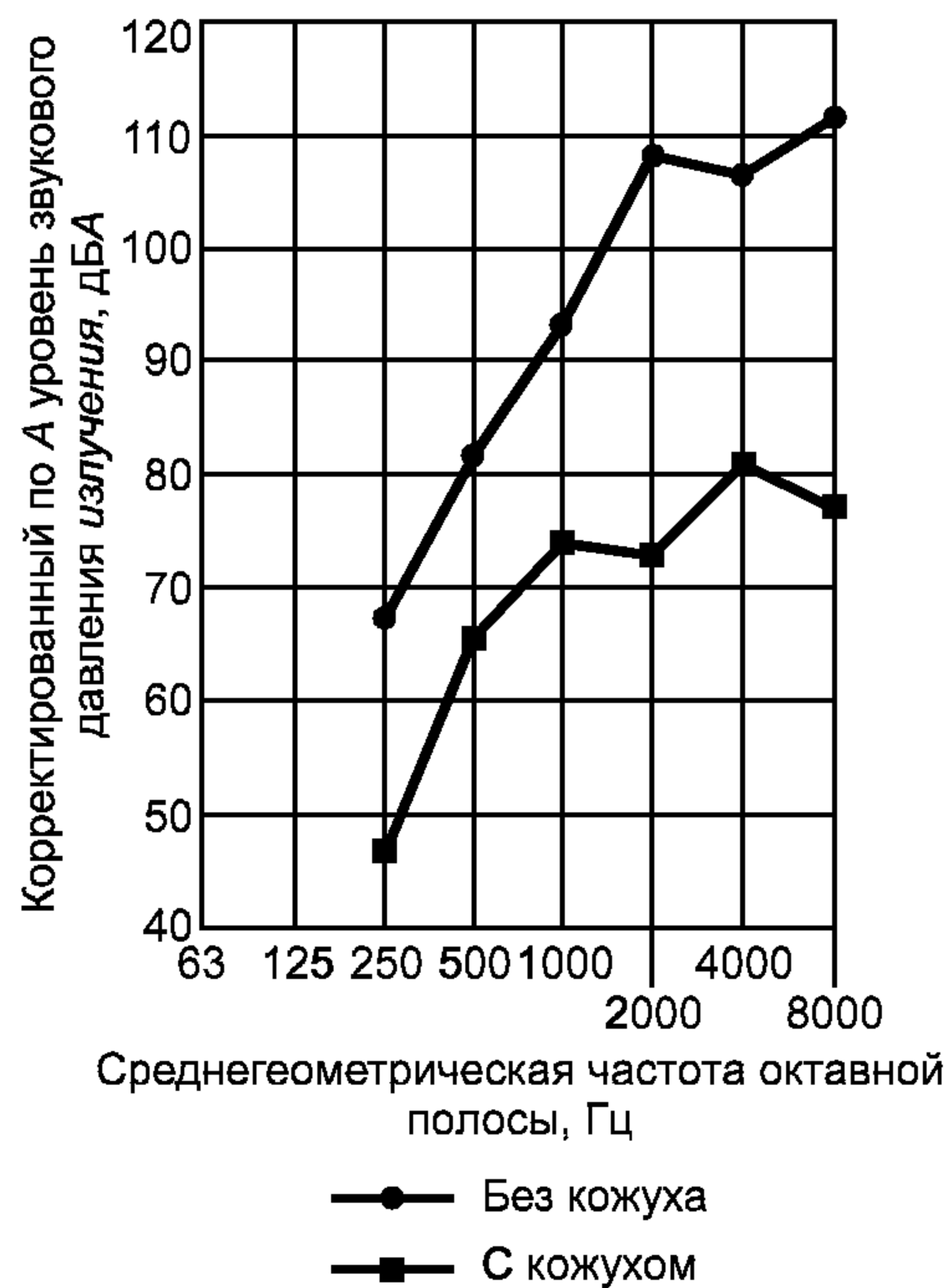
Рисунок В.5 — Спектр скорректированных по А уровней звукового давления излучения на рабочем месте станка с двумя пилами для резки профилей
