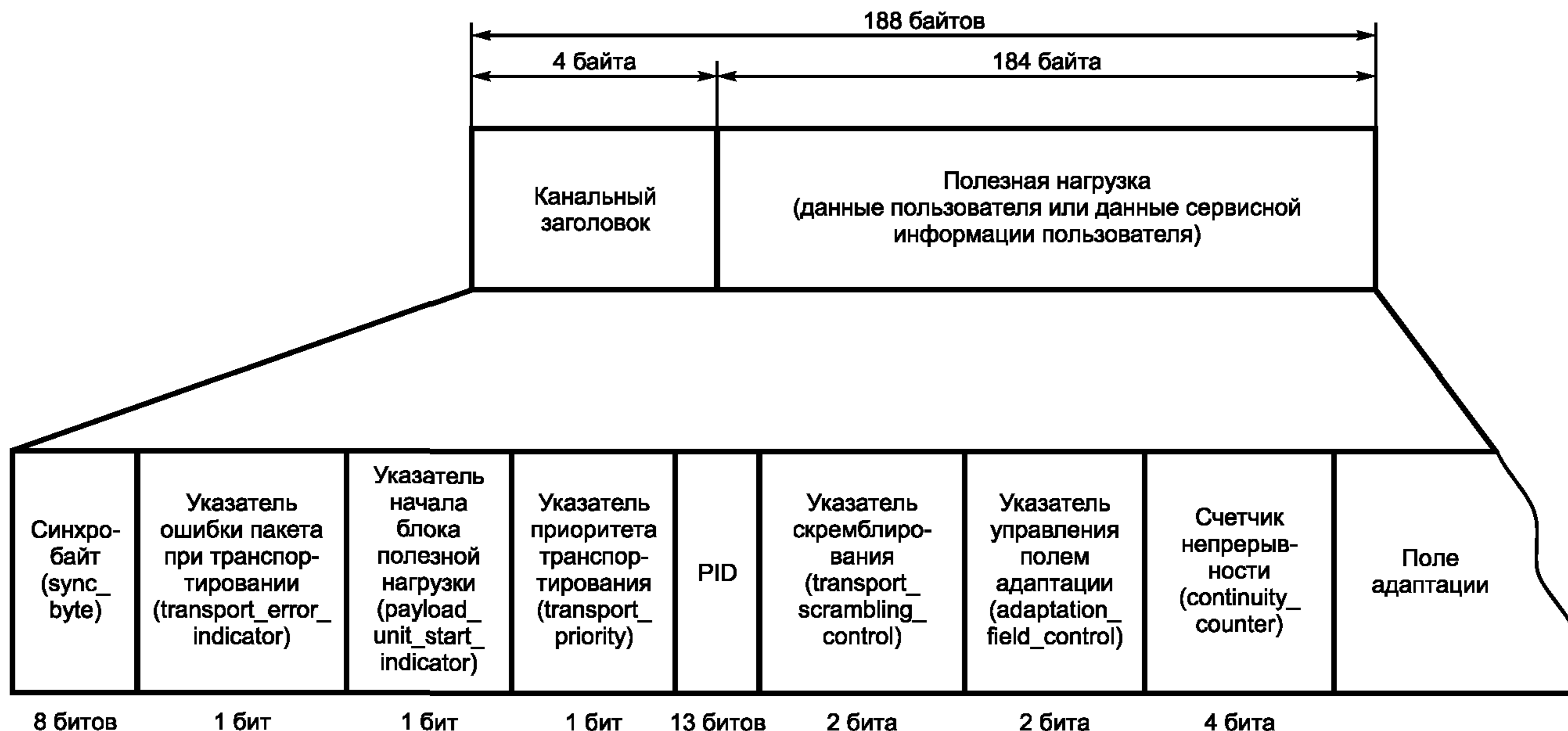
Рисунок 3 — Структура пакетов транспортного потока в системе передачи данных пользователя в цифровом телевизионном формате
