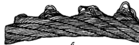
Рис.12. Выдавливание проволок прядей:
