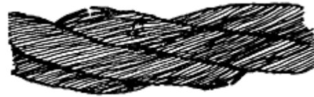
Рис.1. Обрывы и смещения проволок каната крестовой свивки
