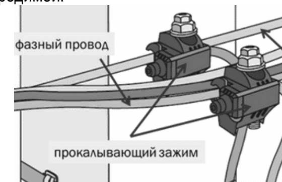
Рисунок 5 Подключение к ВЛИ прокалывающими зажимами
